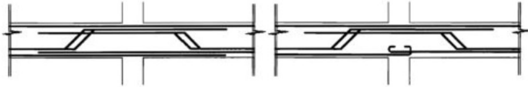
Σχήμα 5-2: Τρόπος όπλισης δοκών κατά την περίοδο μελέτης του κτιρίου, στ' αριστερά: λεπτομέρεια περιμετρικού πλαισίου, στα δεξιά: λεπτομέρεια εσωτερικού πλαισίου
