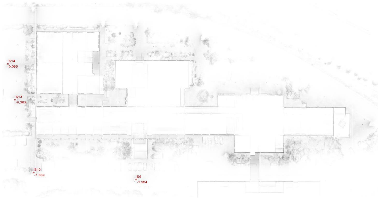
Εικόνα 79: Σκαρίφημα θέσης τοποσταθερών που χρησιμοποιήθηκαν για την γεωαναφορά της σάρωσης του εξωτερικού περιγράμματος του κτηρίου Λαμπαδαρίου για επίτευξη RMS \approx 0.020m .
