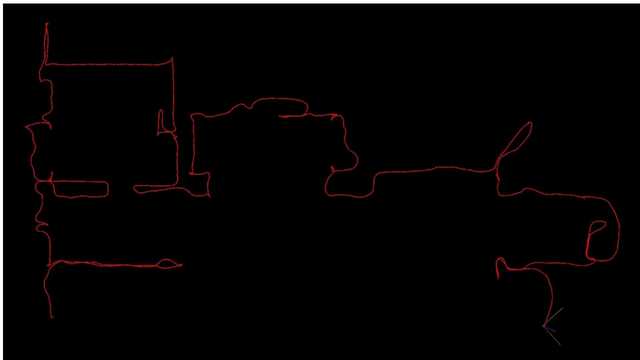
Εικόνα 92: Σκαρίφημα της πορείας που ακολουθήθηκε κατά τη διάρκεια της σάρωσης του εξωτερικού περιγράμματος του κτηρίου Λαμπαδαρίου.
