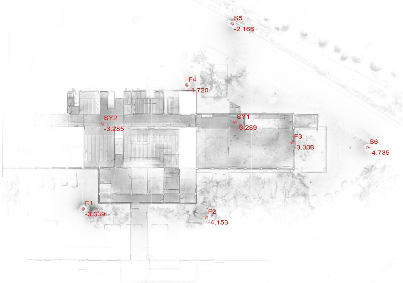
Εικόνα 30: Σκαρίφημα θέσης τοποσταθερών που χρησιμοποιήθηκαν για την γεωαναφορά της σάρωσης του Τομέα 4.
