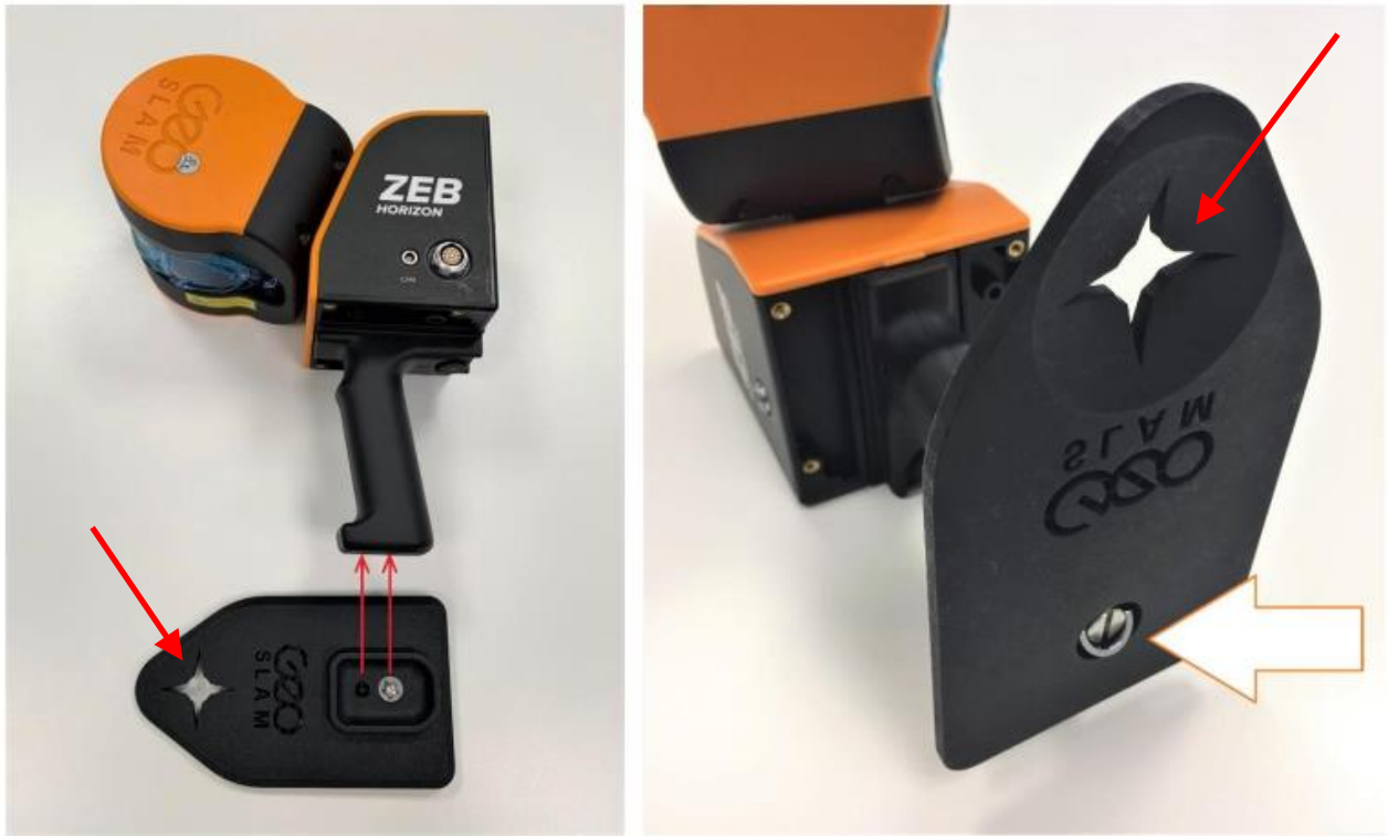
Εικόνα 10: Βάση μέτρησης, όπου με κόκκινο βέλος σημειώνεται το σημείο τοποθέτησης του σαρωτή επί των τοποσταθερών για την καταγραφή τους.
