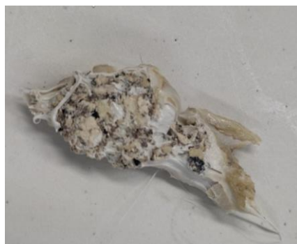
Εικόνα 7: Ακαθαρσίες στα φίλτρα του δικόχλιου εκβολέα
