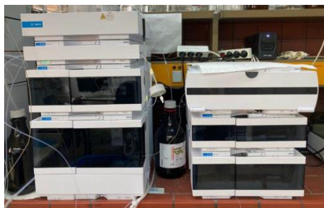
Εικόνα 18: Συσκευή GPC Agilent 1260 Infinity II
