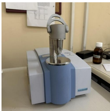
Εικόνα 15: Συσκευή Alpha II της Bruker Optics Inc
