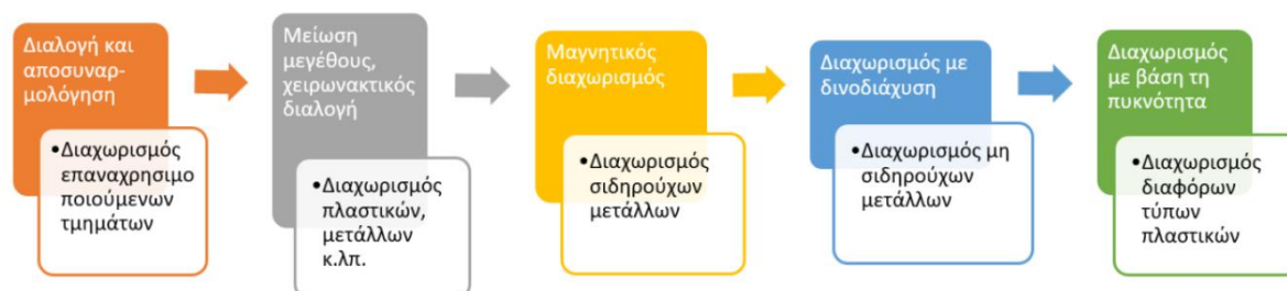
Σχήμα 14: Στάδια προεπεξεργασίας των ΑΗΗΕ
