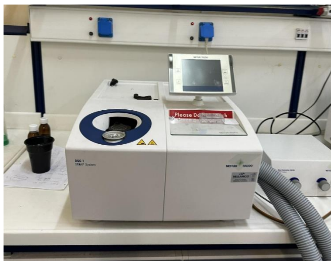
Εικόνα 12: Συσκευή DSC 1/700 StaRe System, Mettler Toledo
