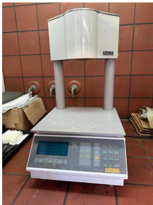
Εικόνα 11: Kayeness 4004 της Dynisco - Όργανο Μέτρησης Ρυθμού Ροής Τήγματος
