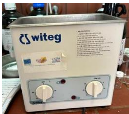
Εικόνα 17: Συσκευή για υποβοηθούμενη ανάδευση – Sonication
