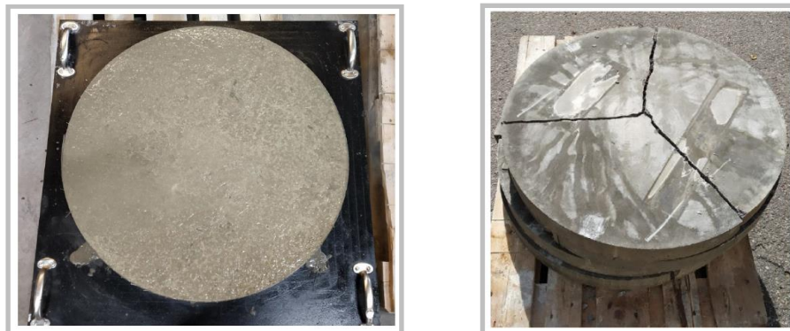
Εικόνα 15: Δοκίμιο έτοιμο για εκτέλεση δοκιμής και δοκίμιο μετά την ολοκλήρωση της δοκιμής με ακτινική ρωγμάτωση ("Laboratory testing of shotcrete with fibres of steel, basalt or synthetic materials", Muralidharan Rengarajan, KTH royal institute of technology)
