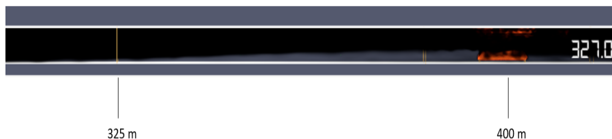
Εικόνα 4-1: Στιγμιότυπο από το 1ο Σενάριο τη χρονική στιγμή t = 327 \text{ sec} , όπου φαίνεται το φαινόμενο διαστρωμάτωσης του καπνού
