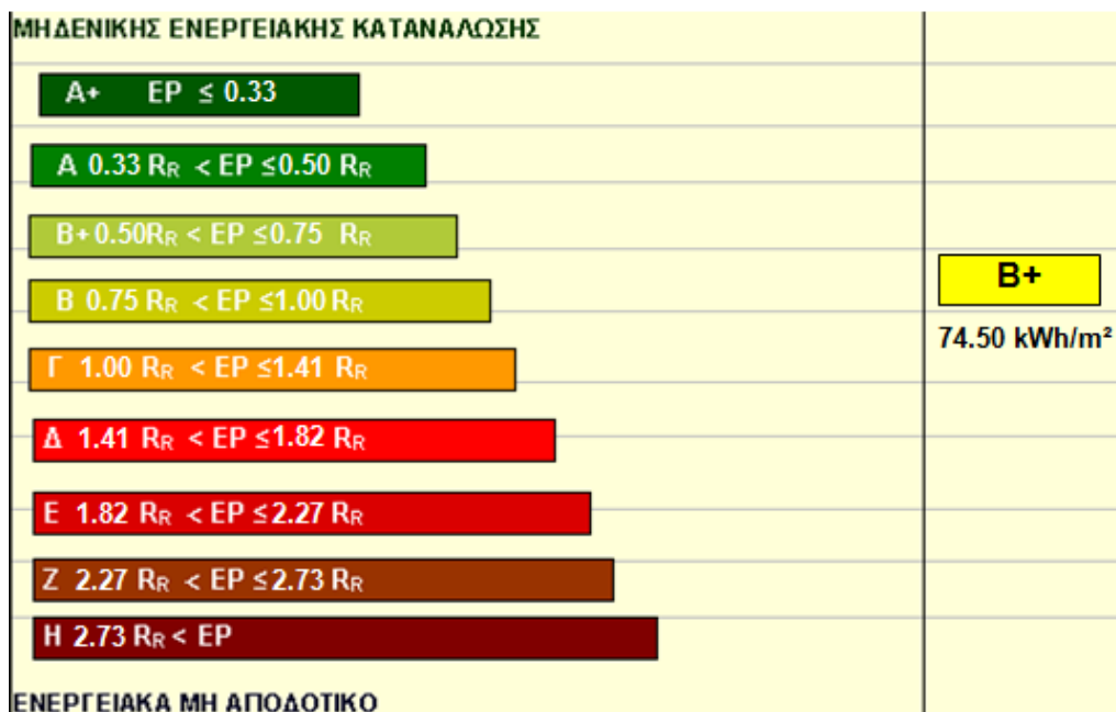
Σχήμα 5.5: Ενεργειακή κατάταξη τμήματος κτιρίου – Σενάριο 3
