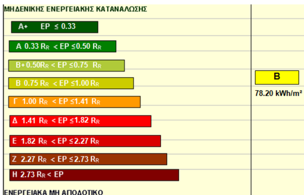
Σχήμα 5.3: Ενεργειακή κατάταξη τμήματος κτιρίου – Σενάριο 1
