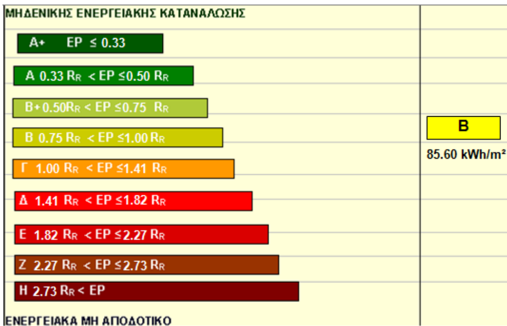
Σχήμα 5.6: Ενεργειακή κατάταξη τμήματος κτιρίου – Σενάριο 4
