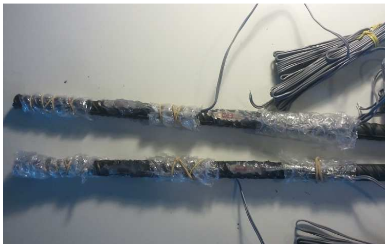
Σχήμα 4.7 Επικάλυψη του οπλισμού για μείωση συνάφειας
