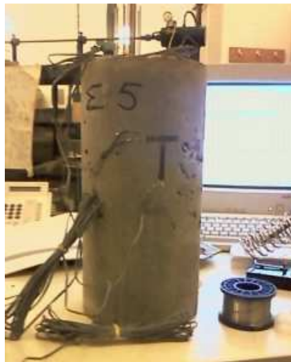
Σχήμα 4.11 Το δοκίμιο με τους εξωτερικούς ηλεκτρικούς μετρητές παραμόρφωσης.
