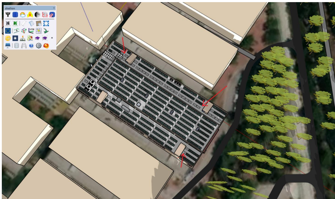
Εικόνα 80. Αφαίρεση φωτοβολταϊκών πλαισίων με απώλειες λόγω σκίασης πάνω από 10% (ενδεικτικά σημειώνονται κάποια με κόκκινα βέλη)
