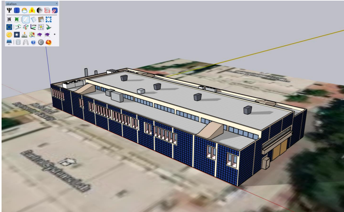
Εικόνα 93. Τοποθέτηση BIPV φωτοβολταϊκών πλαισίων στη νότια και την ανατολική πλευρά του κτιρίου N
