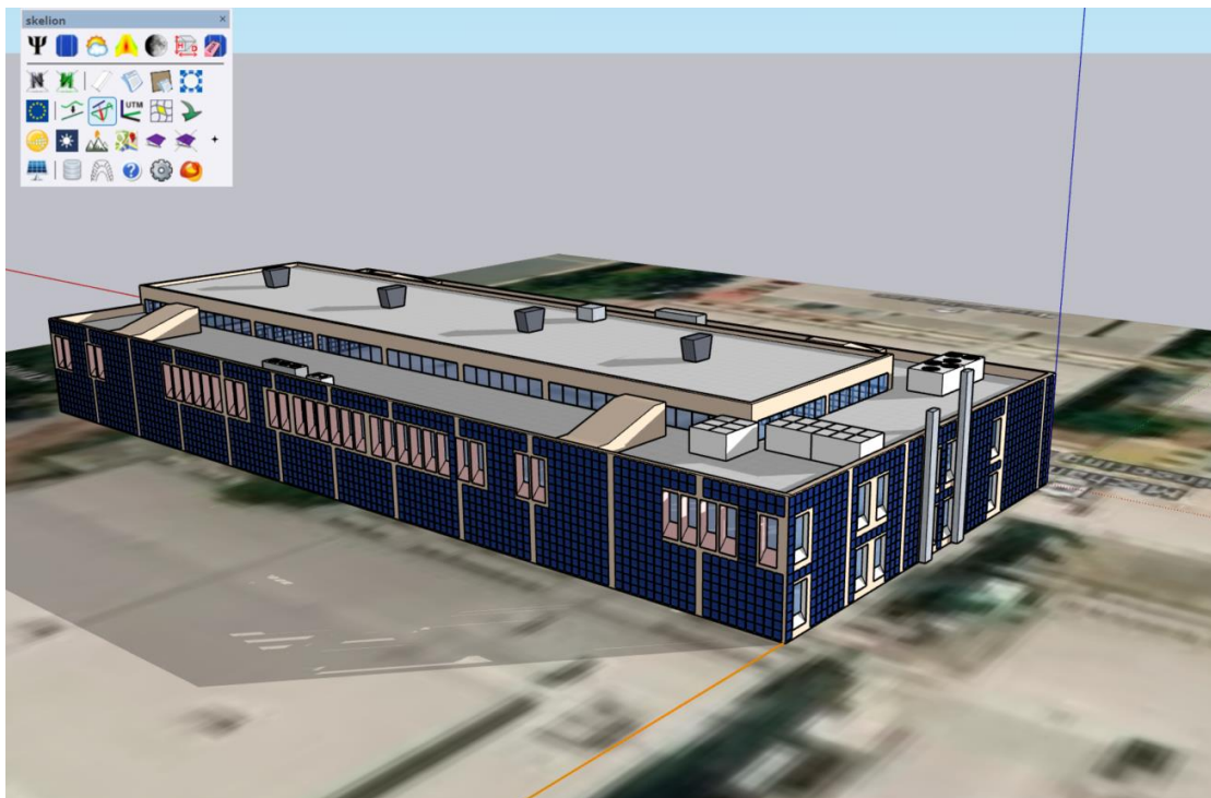
Εικόνα 94. Τοποθέτηση BIPV φωτοβολταϊκών πλαισίων στη βόρεια και δυτική πλευρά του κτιρίου N
