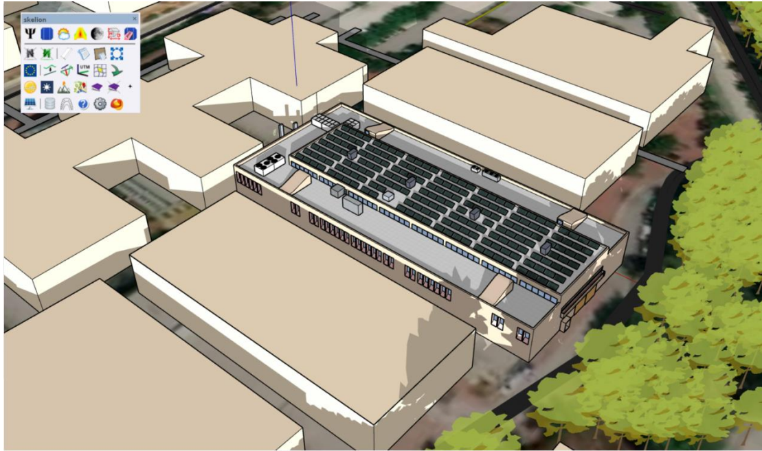
Εικόνα 72. Τοποθέτηση φωτοβολταϊκών πλαισίων στην υπερυψωμένη οροφή του κτιρίου N
