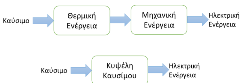
Εικόνα 31:Μετατροπή Ενέργειας σε Μηχανή Εσωτερικής Καύσης και Κυψέλη Καυσίμου.
