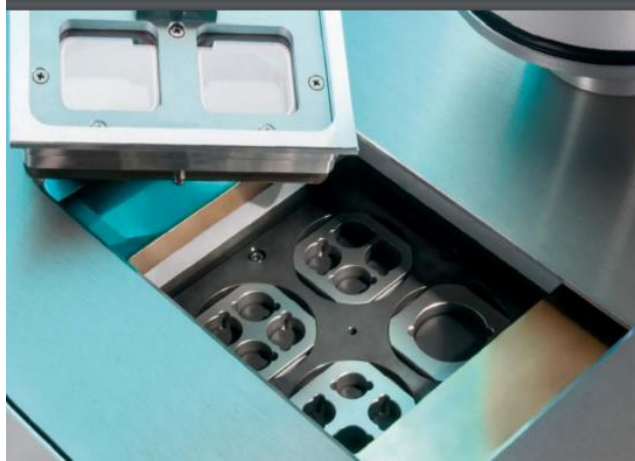
Εικόνα 2.13: Δίσκος με τις θήκες για τα δείγματα της συσκευής LFA 467 HyperFlash [36]
