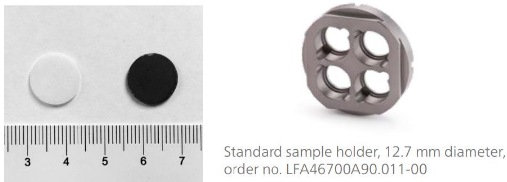
Εικόνα 2.14: Δείγμα πριν και μετά την επικάλυψη με γραφίτη (αριστερά) [37], θήκη τεσσάρων δειγμάτων διαμέτρου 12.7 mm το καθένα για τη συσκευή LFA467 της NETZSCH (δεξιά) [36]
