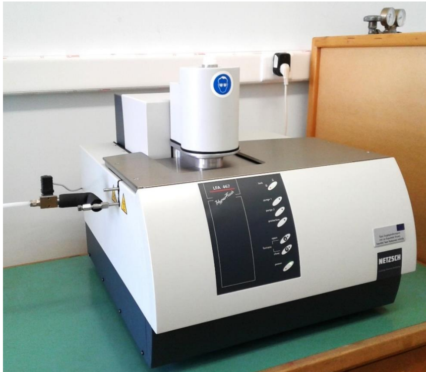
Εικόνα 2.11: Συσκευή LFA 467 HyperFlash της NETZSCH, Εργαστήριο Θερμικής Ανάλυσης, Τομέας Φυσικής, ΕΜΠ
