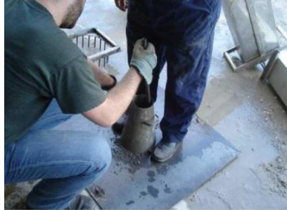
Εικόνα 1.12 Ραβδισμός σκυροδέματος κατά τη δοκιμή κάθισης (Πάσιος 2011).
