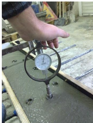
Εικόνα 2.15 Μέτρηση της πίεσης διείσδυσης, με έμπηξη ειδικής βελόνας συνδεδεμένης με δυναμόμετρο, σε διαφορετικές θέσεις δοκιμίου δοκού για τον προσδιορισμό της πήξης του νωπού σκυροδέματος.
