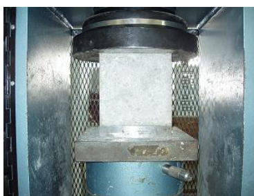
Εικόνα 2.11 Θλίψη κυβικού δοκιμίου (Πάττα και Περβολαράκης 2005).
