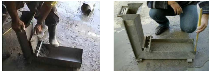
Εικόνα 1.17 (Αριστερά) Άνοιγμα θύρας εκροής δοχείου L κατά την εκτέλεση της δοκιμής, ( Δεξιά ) Μέτρηση ύψους H_{2,L} .
