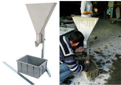
Εικόνα 1.19 Εκτέλεση δοκιμής χοάνης V (V-Funnel) (Στόλος 2011)
