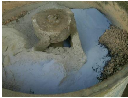
Εικόνα 2.6 Αναμικτήρας σε ακινησία κατά την προσθήκη των λεπτόκοκκων υλικών (με χαρακτηριστικό κυανό χρώμα διακρίνεται η πυριτική παιπάλη (sf)) (Στύλος 2011).
