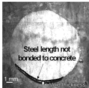
Εικόνα 1.28 Διεπιφάνεια χάλυβα-σκυροδέματος μεγεθυμένη κατά 25 φορές με μικροσκόπιο-κάμερα (Soylev T. και Francois R. 2006).
