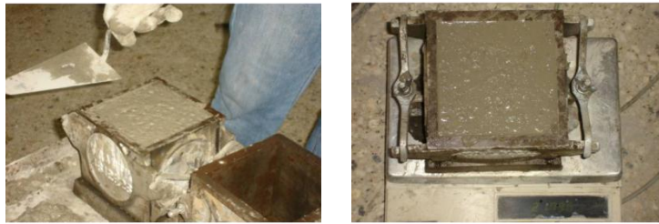
Εικόνα 2.9 (Αριστερά) Επιπεδοποίηση εξωτερικής επιφάνειας νοπού σκυροδέματος σε μήτρα (με μυστρί), (Δεξιά) μέτρηση μεικτού βάρους (νοπό σκυρόδεμα και μήτρα) (Σφήκας 2007).
