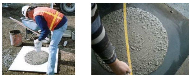
Εικόνα 1.14 (Αριστερά) Κατακόρυφη ανασήκωση κώνου κατά την διεξαγωγή δοκιμής εξάπλωσης, (Δεξιά) μέτρηση τελικής διαμέτρου εξάπλωσης.
