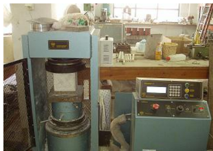
Εικόνα 2.10 Μηχανή θραύσης Wykeham Farrance (Πάττα και Περβολαράκης 2005).
