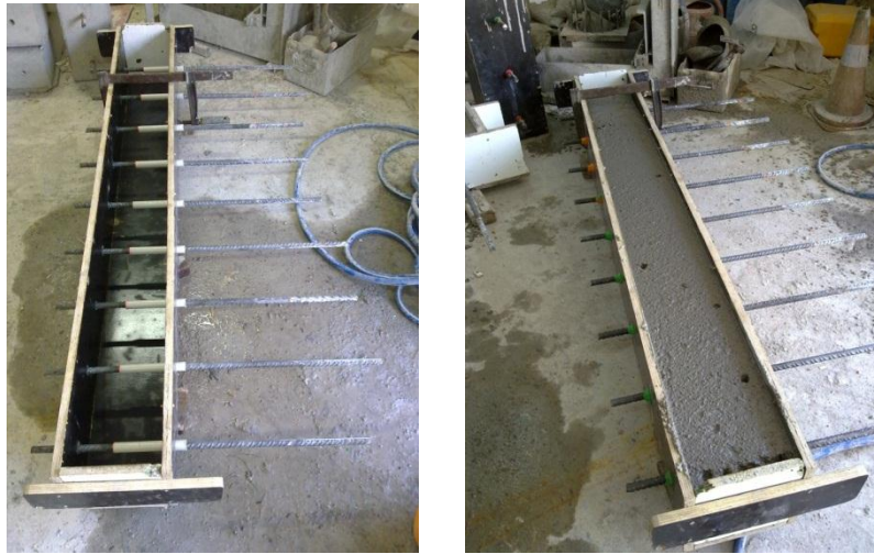
Εικόνα 2.7 (Αριστερά) Ξυλότυπος δοκιμίου δοκού λίγο πριν την πλήρωση (με χαρακτηριστικό 'γυάλισμα' φαίνεται το ειδικό έλαιο επάλειψης), (Δεξιά) Δοκίμιο δοκού λίγο μετά τη σκυροδέτηση, ενώ βρίσκεται σε νωπή κατάσταση (και πριν την έναρξη της πήξης). Φαίνονται ως 'τρύπες' τα σημεία από τον έλεγχο της πήξης (βλέπε την §2.3.3).
