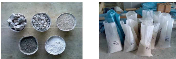
Εικόνα 2.5 (Αριστερά) Αδρανή-Τσιμεντοειδή υλικά, (Δεξιά) συλλογή υλικών σε πλαστικές σακούλες, πριν την σφράγιση (Σφήκας 2007).
