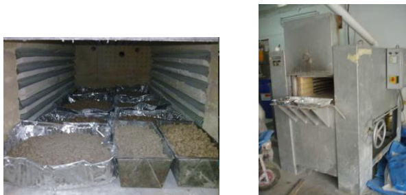
Εικόνα 2.4 (Αριστερά) Ξήρανση αδρανών, (Δεξιά) κλίβανος Εργαστηρίου (Πάλμος και Σωτηροπούλου 2010).
