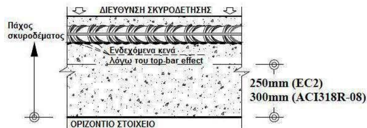
Εικόνα 1.24 Το πρόβλημα των άνω οπλισμών (top-bar effect).
