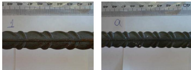
Εικόνα 1.37 (Αριστερά) Νευρώσεις «τύπου 1» και, (Δεξιά) νευρώσεις «τύπου 2» (Βαγγελή και Χρηστάκης, 2008).
