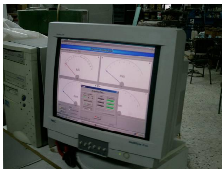
Εικόνα 2.14 Καταγραφή, σε πραγματικό χρόνο, της δύναμης εξόλκευσης (kN) και των τριών ολισθήσεων (mm) όπως προκύπτουν από τα 3 βελόμετρα (LVDTs) της δοκιμής εξόλκευσης, χρησιμοποιώντας το πρόγραμμα StrainSmart (Στύλος 2011).
