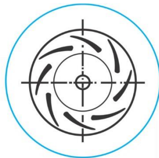
Σχήμα 2.2: Πτερύγια μεταβλητού πάχους με την μορφή αεροτομών.
