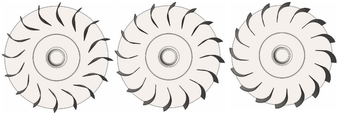
Σχήμα 5.26: Σχεδίαση των περυγίων με γωνίες 0^\circ (αριστερά), 25.5^\circ (κέντρο) και 50^\circ (δεξιά) με την ακτινική διεύθυνση.
