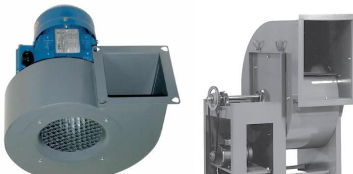
Σχήμα 2.4: Φυγοκεντρικός φυσητήρας με περρωτή με άμεση μετάδοση κίνησης (αριστερά) και με ιμάντα κίνησης.
