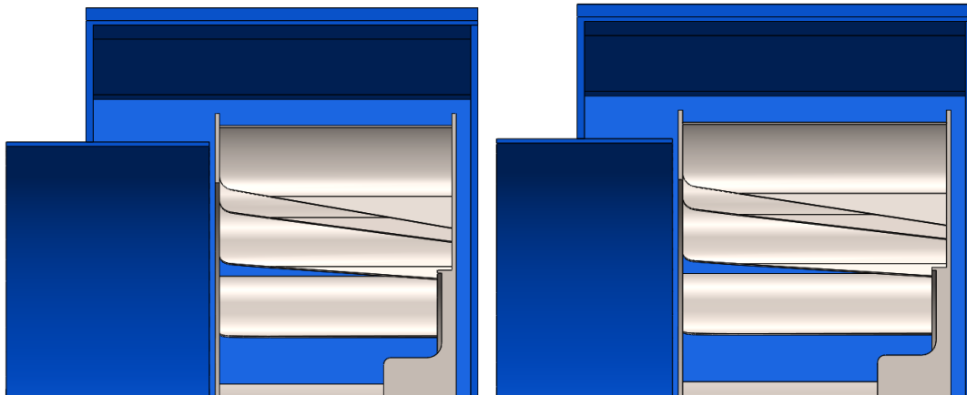
Σχήμα 5.19: Μείωση του αρχικού μήκους του αγωγού εισόδου με την αύξηση του ύψους των πτερυγίων της περωτής.
