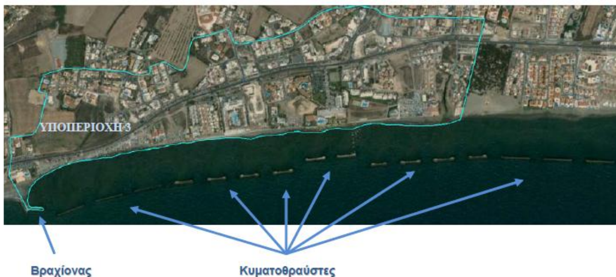
Εικόνα 4.12: Υποπεριοχή 3 και κυματοθραύστες που κατασκευάστηκαν τα προηγούμενα έτη για την προστασία της ακτής από τη διάβρωση.
