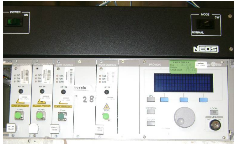
Εικόνα 4.5 Γεννήτρια των CW σημάτων στα 3 μήκη κύματος.
