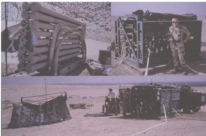
Σχ. 4.6 Μονάδα παραγωγής νερού με αντίστροφη ώσμωση. Πάνω αριστερά: Φίλτρα μεμβράνης της μονάδας. Πάνω δεξιά: Η μονάδα επεξεργασίας. Κάτω: Άποψη της πλήρους μονάδας και του υδροφόρου οχήματος.
