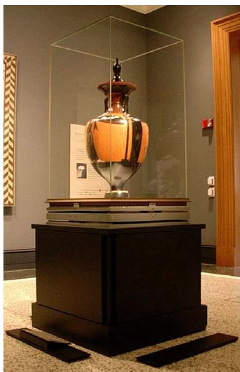
Σχ. 1.7: Ο προστατευόμενος αττικός αμφορέας επί της εξεταζόμενης διάταξης σεισμικής μόνωσης
