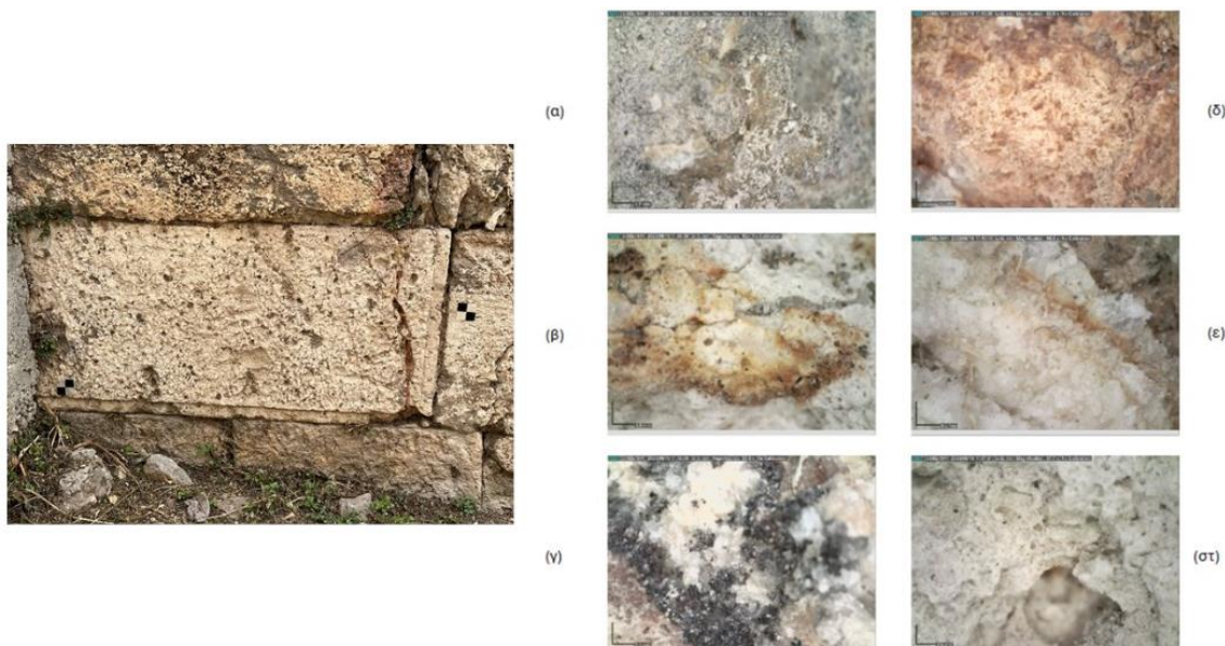
Εικόνα 5.10: Μακροσκοπική εικόνα για Τοιχίο 1, λίθο 7 και εικόνες DM
