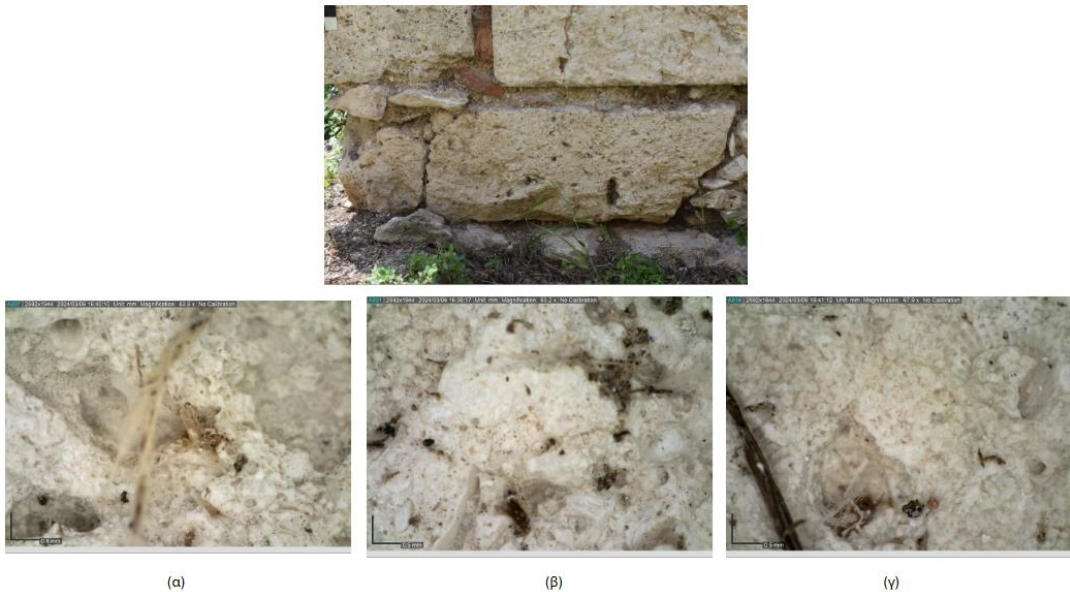
Εικόνα 5.31: Μακροσκοπική εικόνα για Τοίχιο 2, λίθο 22 και εικόνες DM
