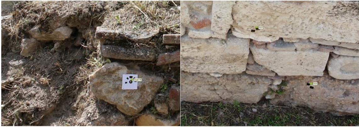
Εικόνα 4.5: Φωτοσταθερά με στόχους metashape (αριστερά), και μεταλλικούς (δεξιά)
