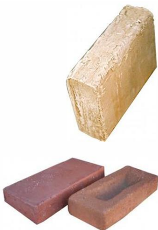
Εικόνα 2.7: Πάνω ωμόπλινθοι, κάτω οπτόπλινθοι, (Πηγή: Διδακτικές Σημειώσεις ΔΠΜΣ «Προστασία Μνημείων» Β' Κατεύθυνση Καθ. ΕΜΠ Αντωνία Μοροπούλου ΕΔΙΠ Κυριάκος Λαμπρόπουλος)
