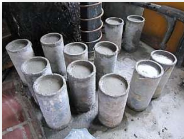
Εικόνα 13: Τα καλούπια μετά την έκχυση – δόνηση του τσιμεντοκονιάματος
