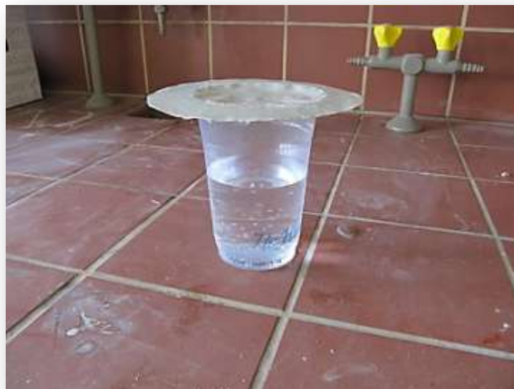
Εικόνα 20: Διάταξη για τη μέτρηση της υδρατμοπερατότητας
