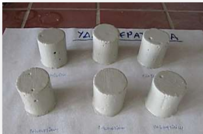
Εικόνα 17: Τα δοκίμια έτοιμα για την έναρξη της μέτρησης Υδατοπερατότητας
