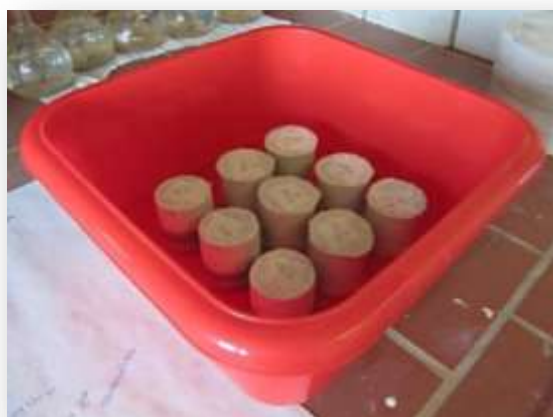
Εικόνα 18: Τα δοκίμια βυθισμένα μέχρι ύψους 1cm σε δοχείο με νερό
