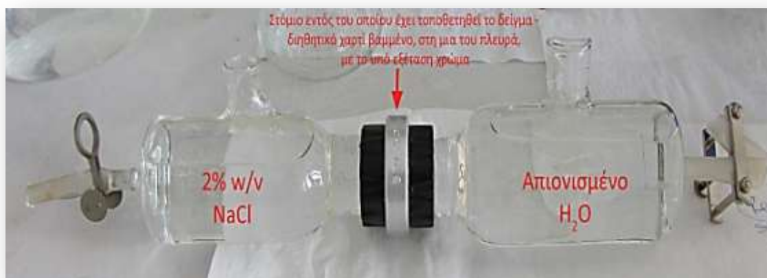
Εικόνα 21: Η πειραματική διάταξη που χρησιμοποιήθηκε για τον υπολογισμό της διαπερατότητας σε χλωριόντα
