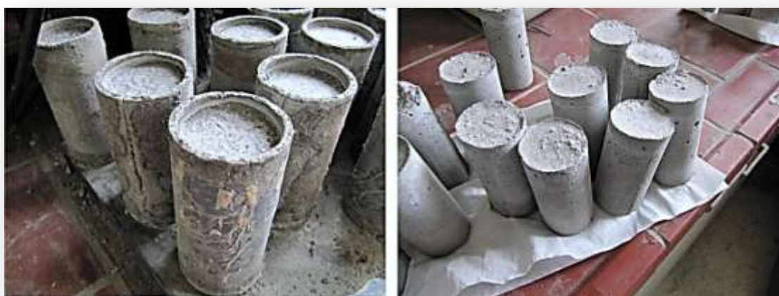
Εικόνες 14 – 15: Τα καλούπια με στερεοποιημένο το τσιμεντοκονίαμα (αριστερά) και τα δοκίμια μετά την απομάκρυνση των καλουπιών (δεξιά)
