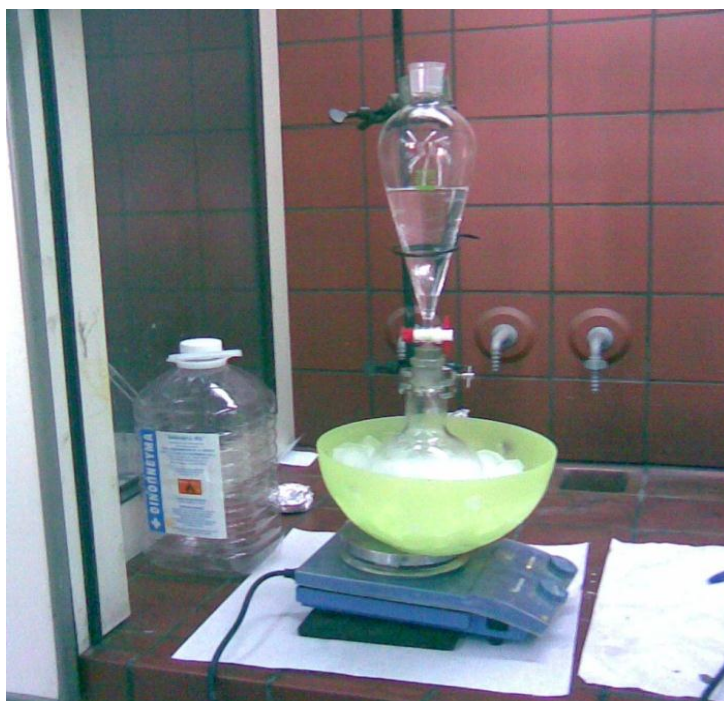
Σχήμα 5.2: Πειραματική διάταξη παρασκευής ημιαρωματικού πολυαμιδικού άλατος 6.Τ.
