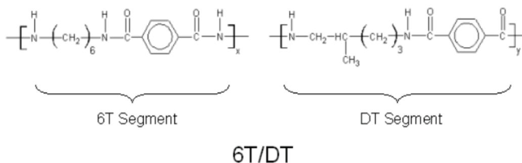
Σχήμα 2.6: Χημική δομή του εμπορικού πολυφθαλαμιδίου PA6.T/DT [2].
