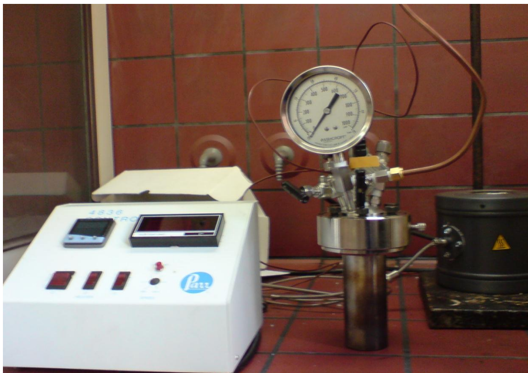
Σχήμα 6.7: Φωτογραφία όπου διακρίνεται ο αντιδραστήρας της Parr Instruments στον οποίο πραγματοποιήθηκαν οι πολυμερισμοί των αλάτων. Διακρίνεται επίσης ο ρυθμιστής και ο θερμαντικός μανδύας.
