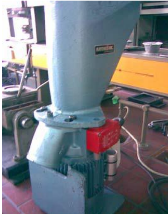
Σχήμα 6.8: Σπαστήρας της Kayeness, όπου γίνεται η κοκκοποίηση των πολυαμιδίων.
