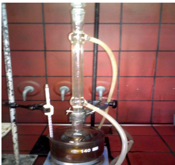
Σχήμα 5.3: Πειραματική διάταξη παρασκευής ημιαρωματικού πολυαμιδικού άλατος 12.T.
