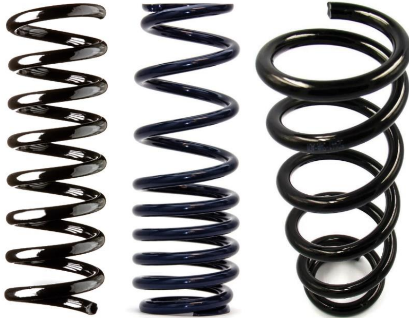
Σχήμα 2.17 Απλό ελικοειδές ελατήριο, ελατήριο μεταβλητής ακαμψίας, κωνικό ελατήριο [6]
