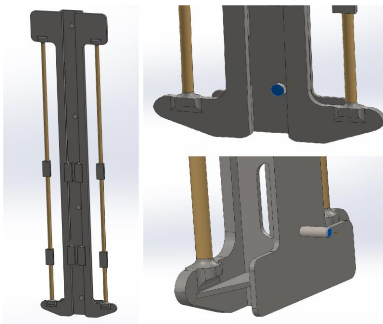
Σχήμα 7.19 Κοχλιοσύνδεση επιτοίχιας βάσης με τον τοίχο
