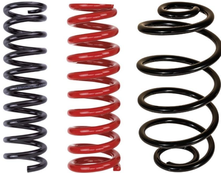
Σχήμα 2.19 Ελατήριο με ουρά, κλειστού άκρου, τετραγωνισμένου άκρου [6]
