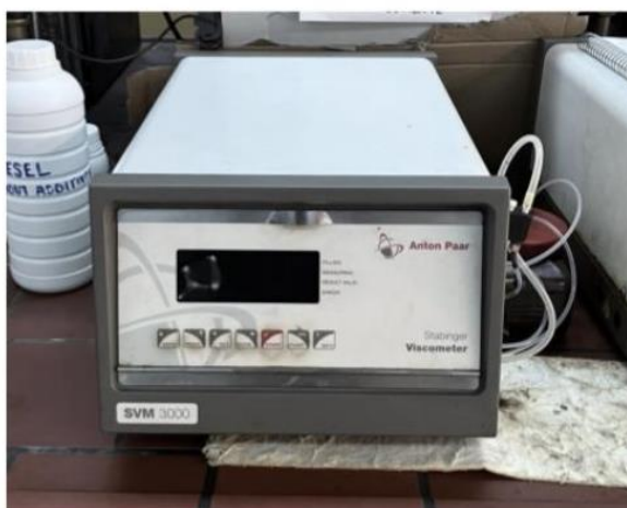
Εικόνα 7 Ηλεκτρονικό ιξωδόμετρο Stabinger SVM 3000 της Anton Paar
