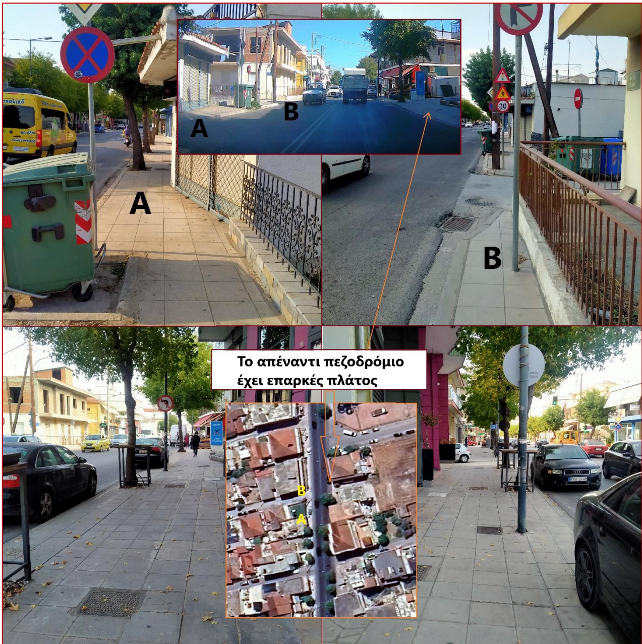
Ομάδα φωτ. 6.2.9 – Δύο σημεία στένωσης του βόρειου πεζοδρομίου (επάνω), το νότιο με επαρκές εύρος (κάτω, και η πάνω εμβόλιμη).
