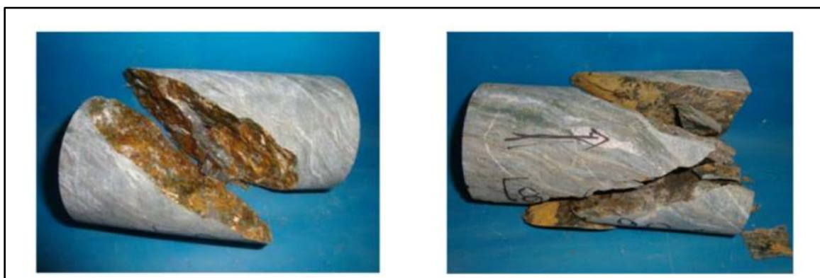
Εικόνα 4. 1: Δοκίμια πρασινοσχιστόλιθου τα οποία έχουν αστοχήσει κατά μήκος μίας επιφάνειας αδυναμίας (σχιστότητας) κατά την δοκιμή ανεμπόδιστης θλίψης.
