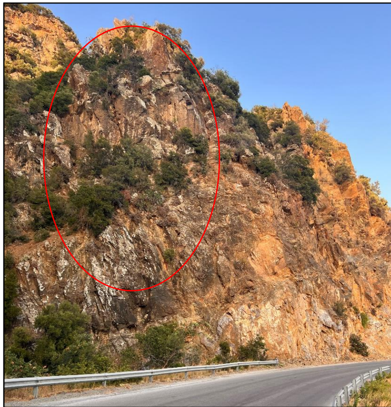
Εικόνα 4. 2: Π1 Τεμαχώδης – Πολύ τεμαχώδης Πρασινιτική – Πρασινοσχιστολιθική βραχομάζα, συμπαγής αδιατάρακτη έως μερικώς διαταραγμένη.
