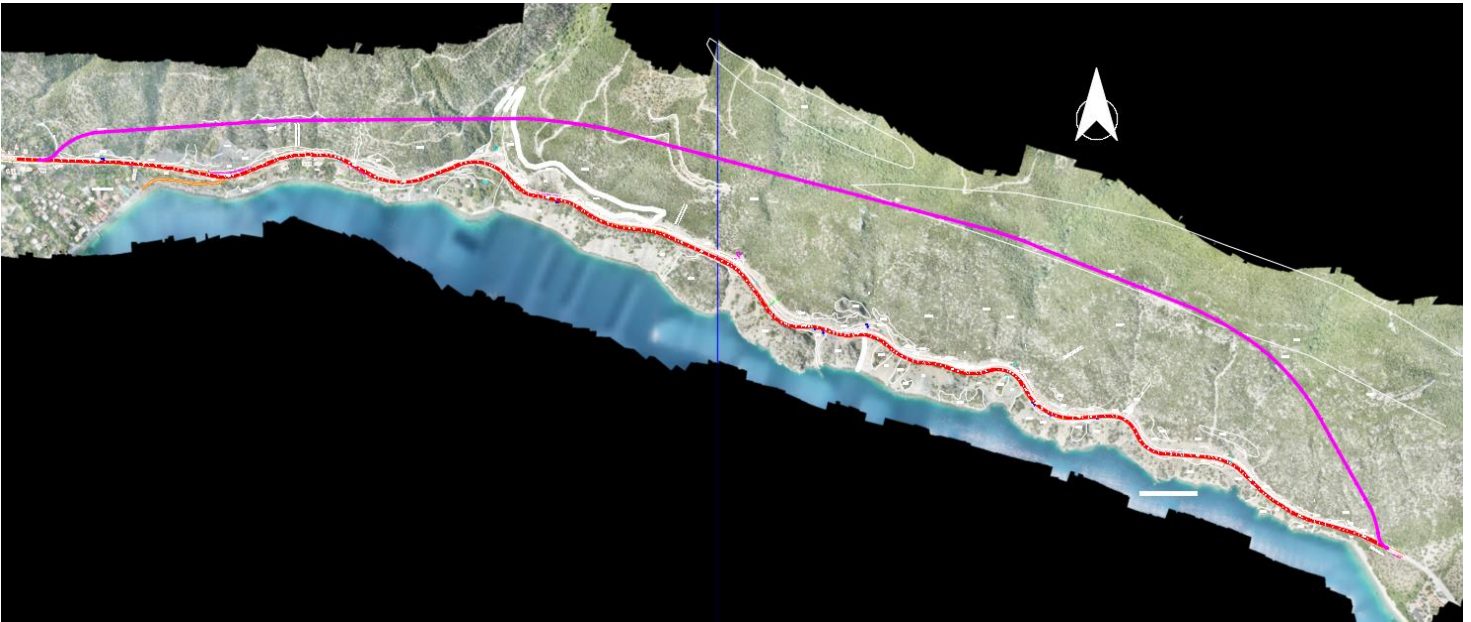
Εικόνα 1. 8: Οριζοντιογραφία της υπό έρευνα σήραγγας (ροζ χρώμα) στην οποία παρουσιάζεται και το ανάγλυφο του εδάφους. Παράλληλα, με κόκκινο χρώμα διακρίνεται η υφιστάμενη επαρχιακή οδός Λουτρών Αιδηψού – Ροβιών. Αριστερά στην εικόνα φαίνεται ο οικισμός Ήλια ενώ στο νότιο τμήμα ο Βόρειος Ευβοϊκός κόλπος.
