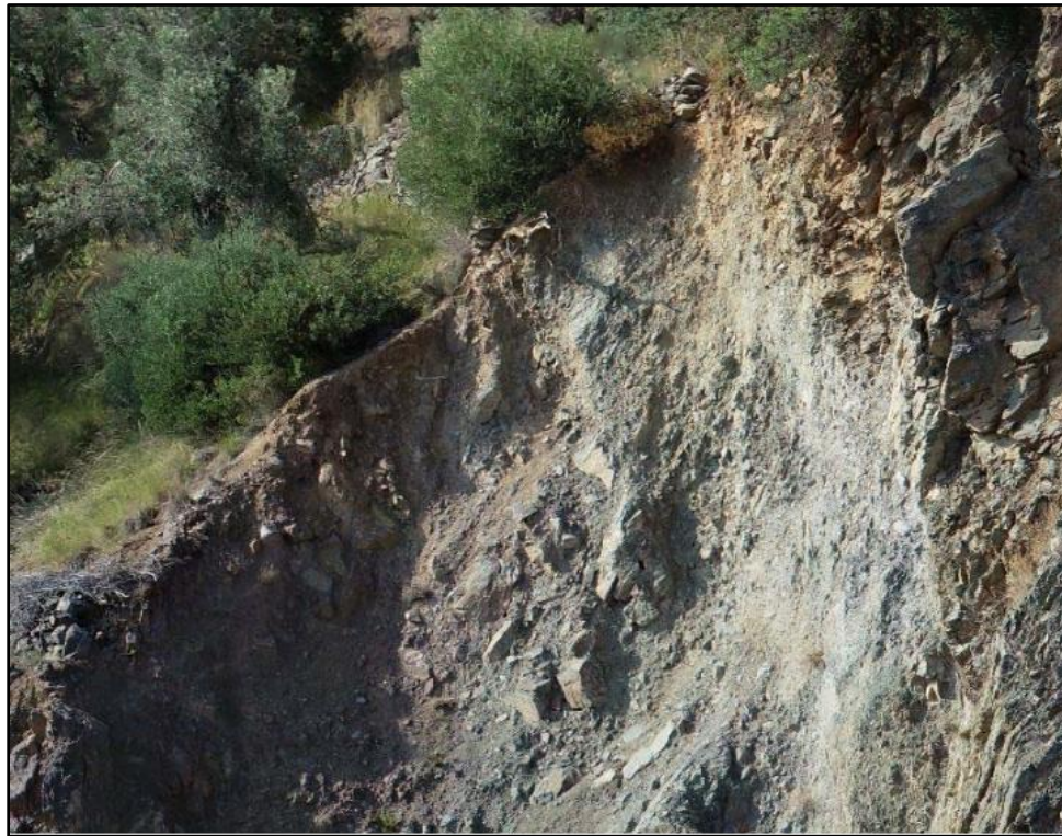
Εικόνα 4. 4: Π3 Κερματισμένη – διαταραγμένη πρασινιτική - πρασινοσχιστολιθική βραχόμαζα, μετρίως αποσαθρωμένη, λόγω του έντονου κερματισμού δύναται να εκδηλώσουν αστοχίες με τη μορφή κατάρρευσης της μάζας τους.
