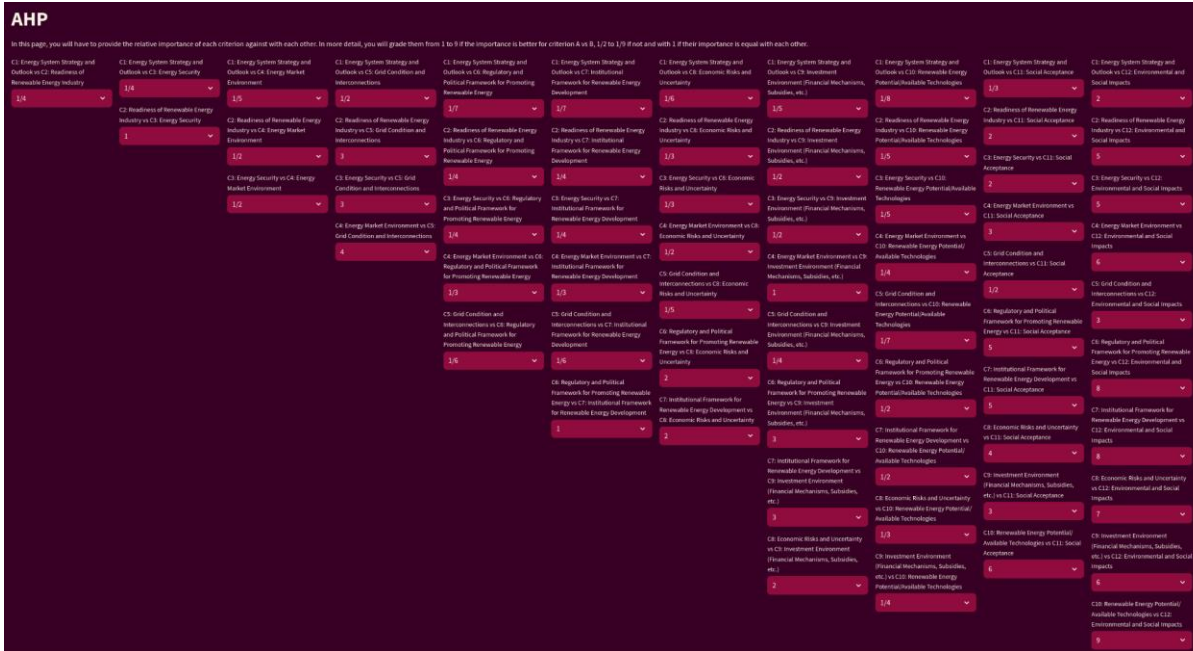
Σχήμα 5.8: Το κύριο μέρος της εφαρμογής όταν έχει επιλεγεί η καρτέλα Criteria Weights . Παρουσιάζονται οι προεπιλεγμένες τιμές του πίνακα A του αλγορίθμου AHP. Παρουσιάζεται μόνο το άνω τριγωνικό μέρος λόγω της ιδιότητας των στοιχείων να είναι αντιστρόφως ανάλογα με άξονα συμμετρίας την κύρια διαγώνιο.
