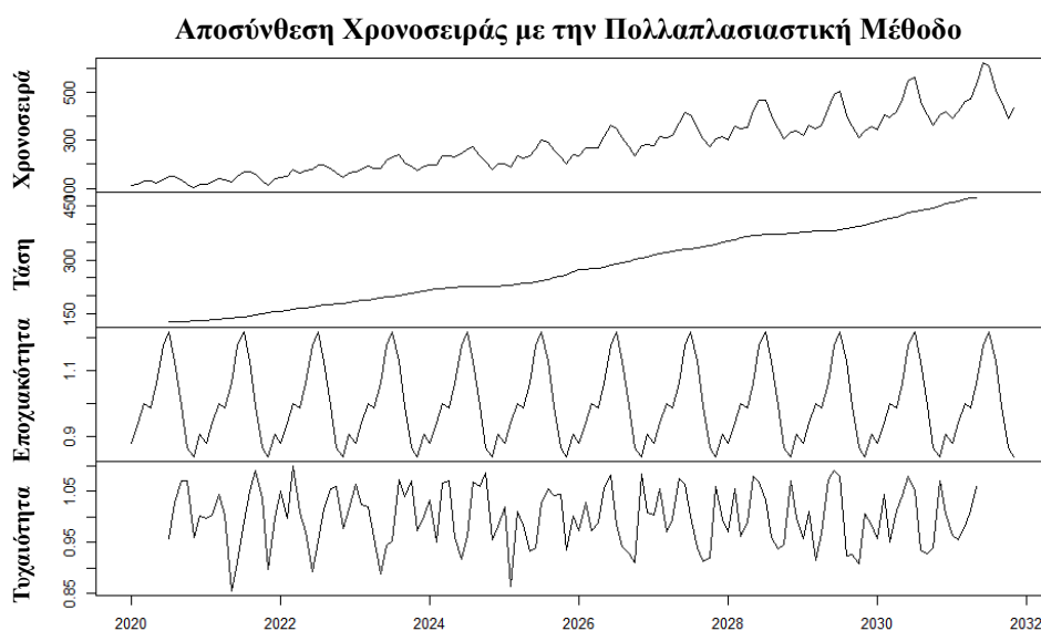
Σχήμα 5.2: Παράδειγμα αποσύνθεσης χρονοσειράς με πολλαπλασιαστικό μοντέλο χρησιμοποιώντας το πακέτο stats της προγραμματιστικής γλώσσας R σε συνιστώσες τάσης, εποχιακότητας και τυχαιότητας.
