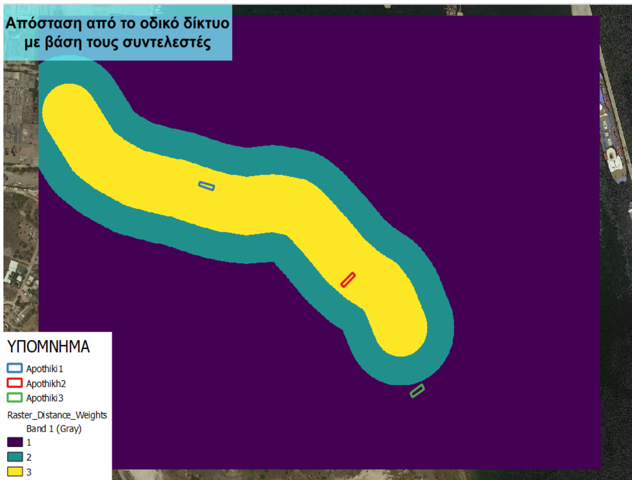
Εικόνα 6.13 : Raster Calculator με βάση τους συντελεστές για το οδικό δίκτυο
