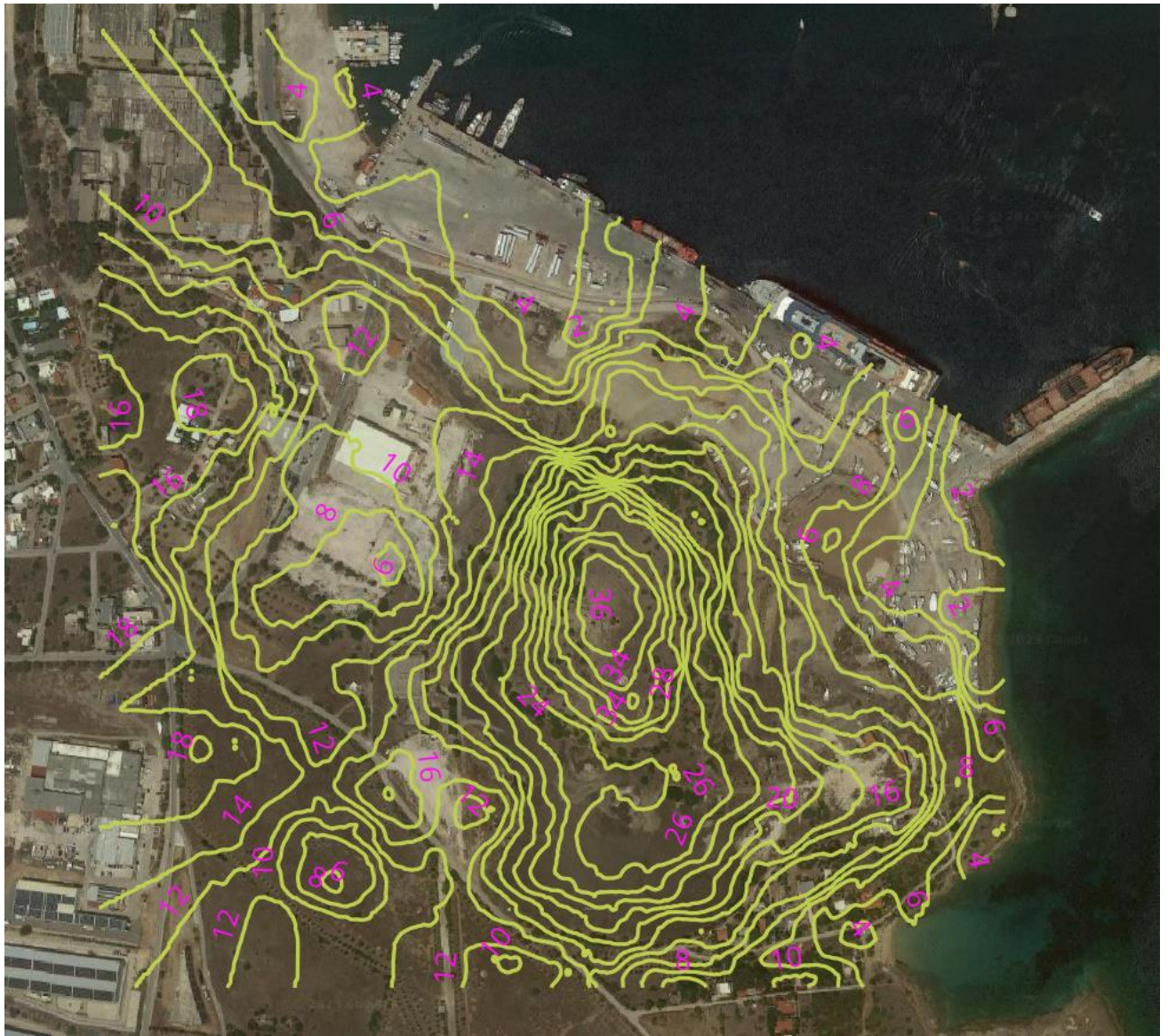
Εικόνα 4.9 : Ισοϋψείς ψηφιακού μοντέλου από drone
