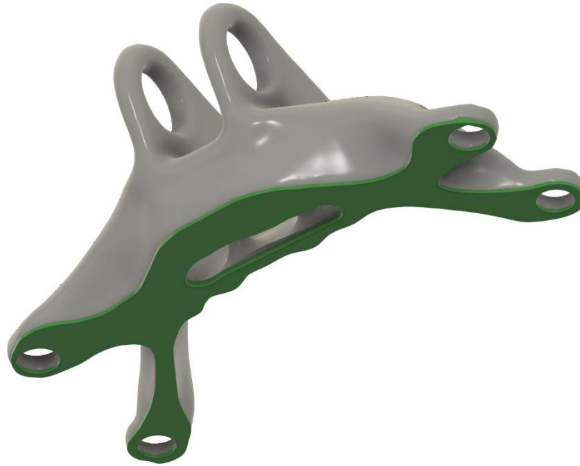
Εικόνα 92. Πρόταση επανασχεδιασμού του Solid. Με μπλε είναι σημειωμένη η επιφάνεια που θα χρειαστεί επιπρόσθετη κατεργασία ώστε να επιτευχθεί η κατάλληλη επιπεδότητα.
