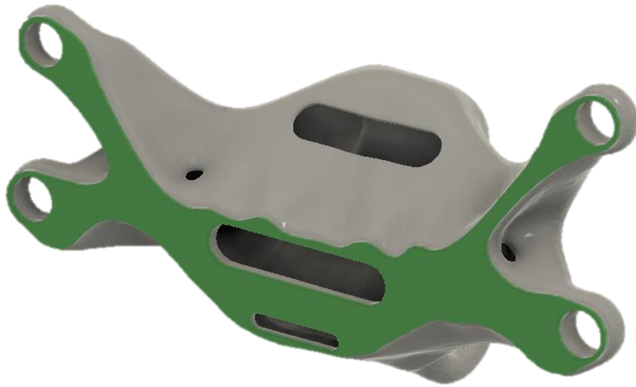
Εικόνα 94. Πρόταση επανασχεδιασμού του Shell. Με μπλε είναι σημειωμένη η επιφάνεια που θα χρειαστεί επιπρόσθετη κατεργασία ώστε να επιτευχθεί η κατάλληλη επιπεδότητα.
