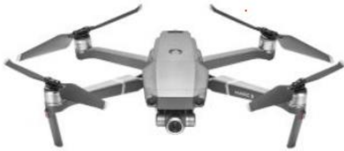
Εικόνα 1.1-2: Τετρακόπτερο σε δομή σχήματος Χ
