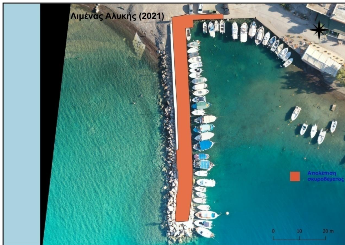
Εικόνα 6-119. Αποτύπωση Λιμένα 3-Αλυκή έτους 2021 ως προς την παράμετρο T.8: Απολέπιση σκυροδέματος. (Πηγή: Tsaimou et al., 2023).
