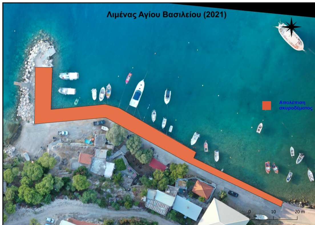
Εικόνα 6-121. Αποτύπωση Λιμένα 4-Άγιος Βασίλειος έτους 2021 ως προς την παράμετρο T.8: Απολέπιση σκυροδέματος. (Πηγή: Tsaitou et al., 2023).
