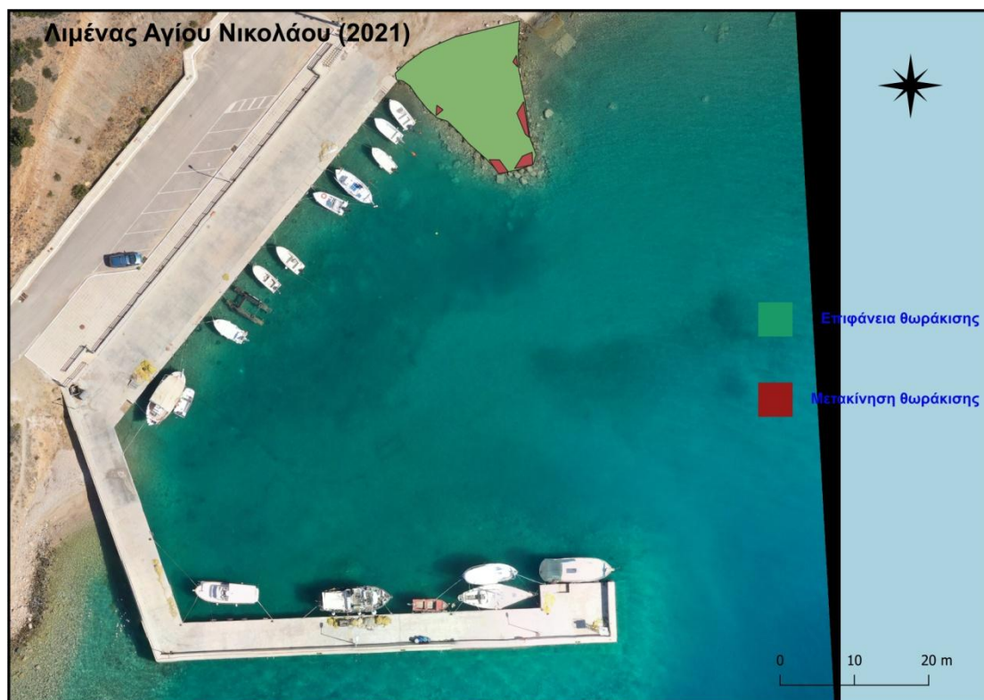
Εικόνα 6-125. Αποτύπωση Λιμένα 2-Άγιος Νικόλαος έτους 2021 ως προς την παράμετρο T.9: Μετακίνηση ογκολίθων θωράκισης έργου προστασίας. (Πηγή: Tsaimou et al., 2023).
