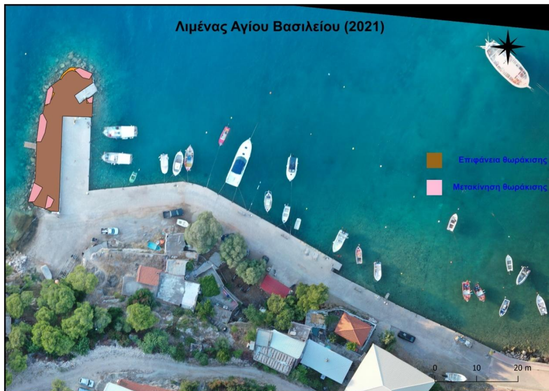
Εικόνα 6-129. Αποτύπωση Λιμένα 4-Άγιος Βασίλειος έτους 2021 ως προς την παράμετρο T.9: Μετακίνηση ογκολίθων θωράκισης έργου προστασίας. (Πηγή: Tsaimou et al., 2023).
