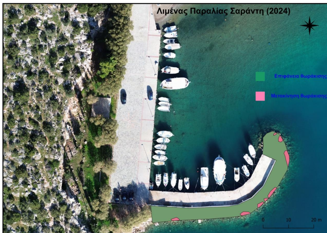
Εικόνα 6-124. Αποτύπωση Λιμένα 1-Παραλία Σαράντη έτους 2024 ως προς την παράμετρο T.9: Μετακίνηση ογκολίθων θωράκισης έργου προστασίας.
