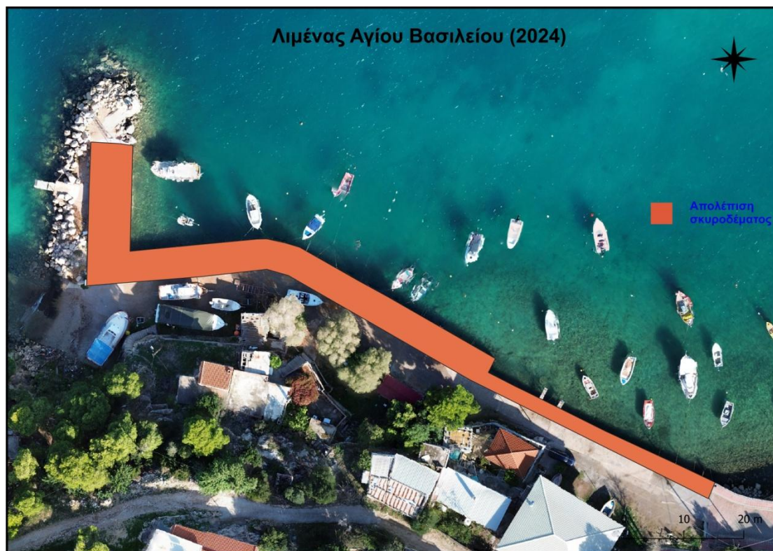
Εικόνα 6-122. Αποτύπωση Λιμένα 4-Άγιος Βασίλειος έτους 2024 ως προς την παράμετρο T.8: Απολέπιση σκυροδέματος.
