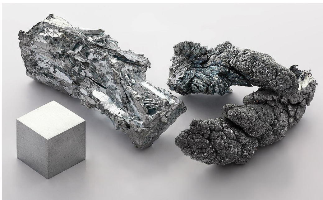
Εικόνα 15: Μεταλλικός ψευδάργυρος καθαρότητας 99,995%. Αριστερά τμήμα κρυστάλλου Zn και δεξιά το μέταλλο σε δενδριτική μορφή. Κυβικός Zn για σύγκριση. 19
