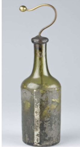
Εικόνα 1: Βάζο Leyden φτιαγμένο από μπουκάλι κρασιού, αγγλικό, γύρω στο 1785. Συλλογή ιστορικών επιστημονικών οργάνων, Πανεπιστήμιο Χάρβαρντ, DW0020 [3]
