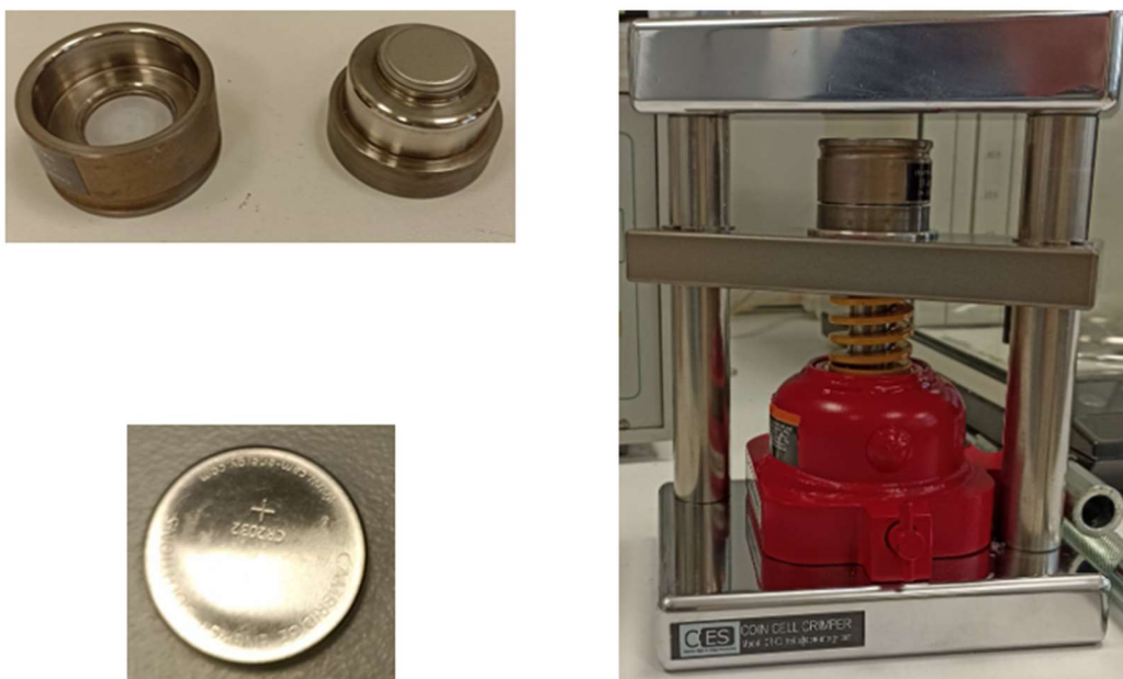
Εικόνα 24: Διαδικασία συμπίεσης με πρέσα για την παραγωγή του coin cell
