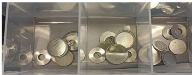
Εικόνα 25: Αποσυναρμολογημένα coin cell, λόγω χρήσης ηλεκτρολύτη 1M, 3M και 6M KOH
