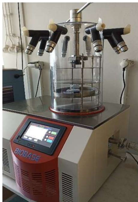
Εικόνα 11: Διάταξη λυοφιλίωσης από την Biobase, που χρησιμοποιείται στη διαδικασία μετατροπής του sol-gel σε xerogel
