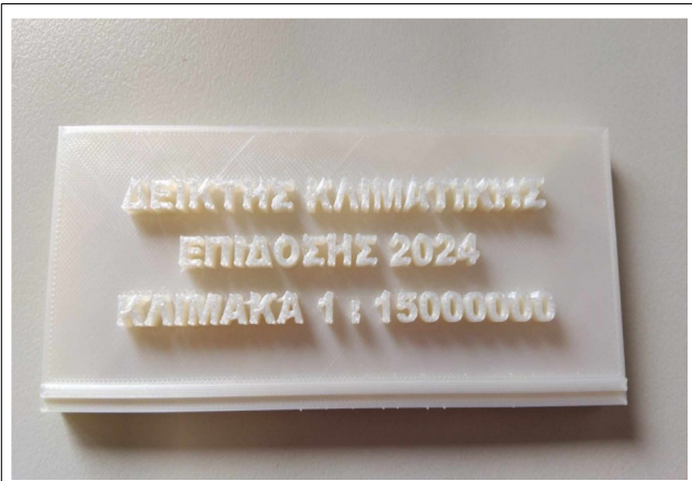
Εικόνα 53: Δοκιμαστική εκτύπωση τμήματος του υπομνήματος με τα γράμματα προεξεχόμενα
