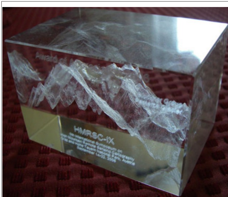
Εικόνα 10: Υποεπιφανειακή χάραξη με χρήση laser ενός ορεινού όγκου γύρω από το Großglockner (3798m) (Weiss and Buchroithner, 2012)
