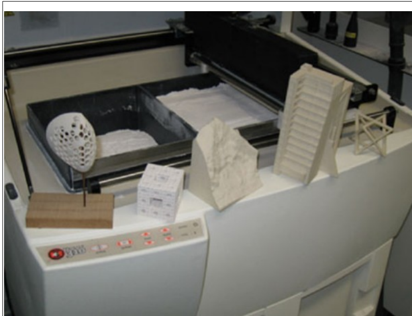
Εικόνα 9: Rapid Prototyping στο Ινστιτούτο Γεωμετρίας, Πανεπιστήμιο Τεχνολογίας, Δρέσδη, Γερμανία (Weiss and Buchroithner, 2012)
