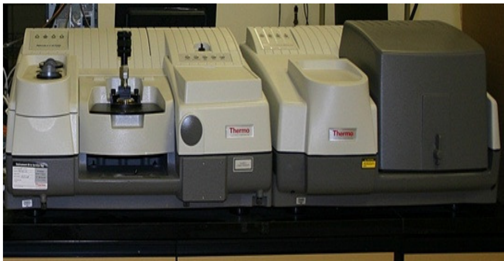
Εικόνα Β.4 Φασματοφωτόμετρο υπερύθρου Nicolet 6700
