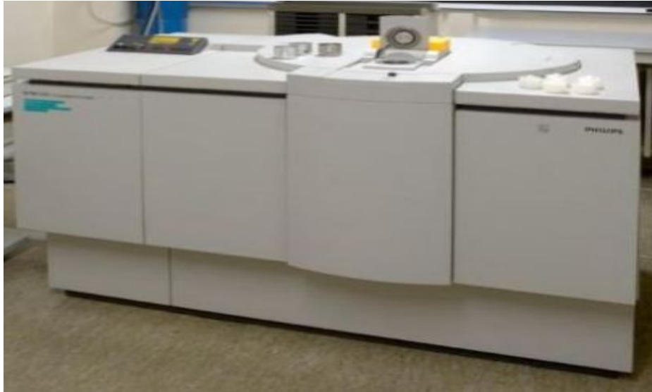
Εικόνα Β.3 Φασματοφωτόμετρο φθορισμού ακτίνων X Phillips PW 2400
