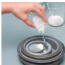
Εικόνα Β.1 Μύλοι τύπου δακτυλίων (ring and puck type)
