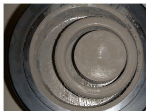
Εικόνα Β.1 Μύλοι τύπου δακτυλίων (ring and puck type)
