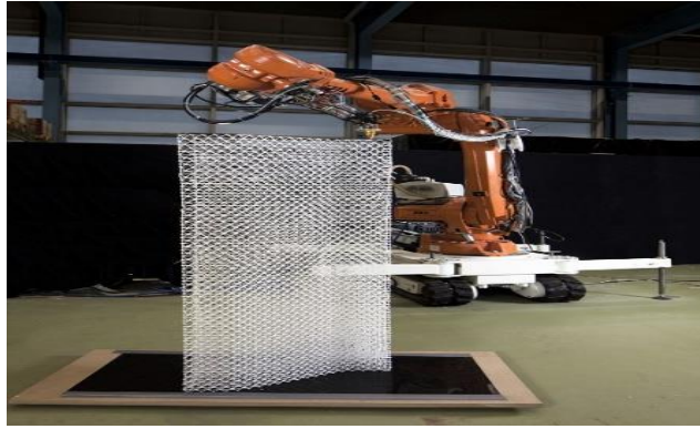
Σχήμα 2-1. Μέθοδος Mesh Mould
