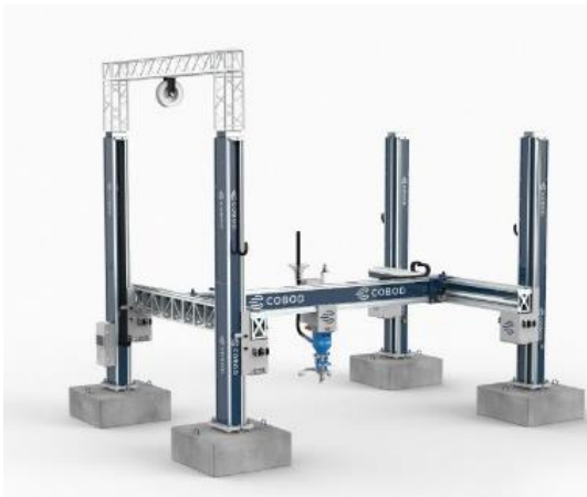
Σχήμα 5-1. Εκτυπωτές 3DCP τύπου gantry
