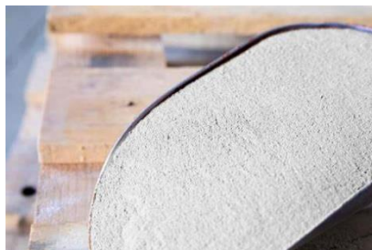
Σχήμα 2-8. Παράδειγμα τσιμέντου για χρήση 3DCP
