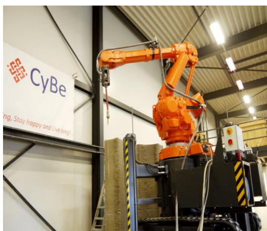
Σχήμα 5-2. (α) Ρομποτικός βραχίονας 3DCP της εταιρείας Cybe, (β) κατασκευή 3DCP
