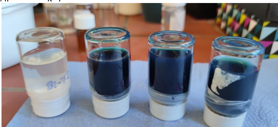
Εικόνα 3.9: Διασπορές νανοσωματιδίων, αριστερά παρατηρούνται νανοσωματίδια CS χωρίς εγκλωβισμένη AICIPc, ενώ οι άλλες τρεις διασπορές περιέχουν εγκλωβισμένη AICIPc
