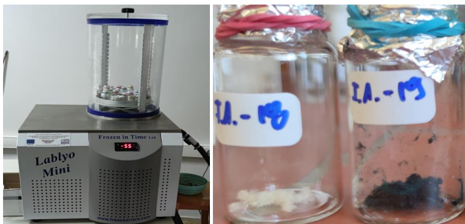
Εικόνα 3.11: Αριστερά: Διάταξη λυοφιλίωσης Lablyo Mini από την Frozen in Time Ltd, Δεξιά: Λυοφιλωμένα νανοσωματίδια CS (λευκά) και νανοσωματίδια CS@AICIPc (πράσινα)
