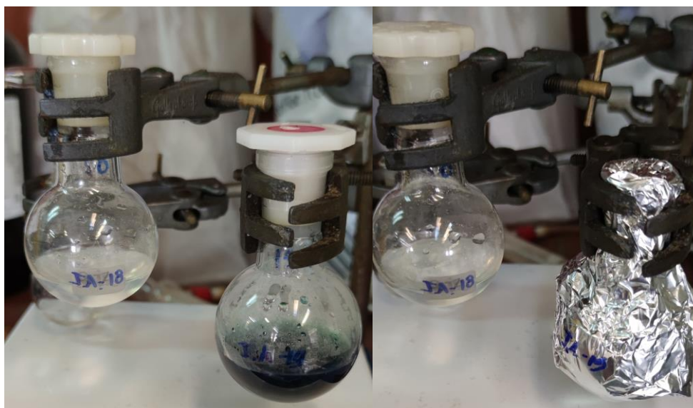
Εικόνα 3.7: Αριστερή εικόνα: σύνθεση νανοσωματιδίων χιτοζάνης χωρίς εγκλωβισμό AICIPc (αριστερά) με εγκλωβισμό AICIPc (δεξιά) πριν την προσθήκη TPP, Δεξιά εικόνα: σύνθεση νανοσωματιδίων χιτοζάνης χωρίς εγκλωβισμό AICIPc (αριστερά) με εγκλωβισμό AICIPc (δεξιά) μετά την προσθήκη TPP
