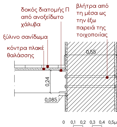
Εικ. 7.1 Λεπτομέρεια μεταλλικής δοκού Π νέου πατώματος ορόφου_Πηγή: προσωπικό αρχείο
