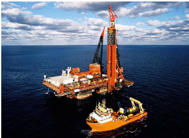
Εικόνα 3- 21. ‘J – lay’, πλευρικό σκάφος στοιβάζει επάνω στο πλοίο τα τμήματα του αγωγού που θα συγκολληθούν. Πηγή: HuismanEquipment.com
