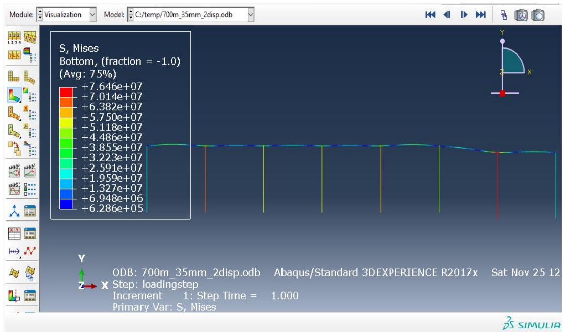
Εικόνα 5- 19. Καθίζηση εδάφους κατά 2 m σε 700 m μήκος αγωγού – Abaqus
