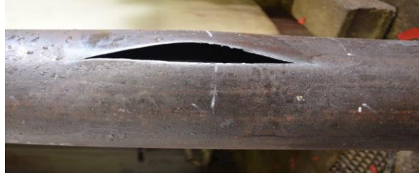
Εικόνα 4- 12. Πείραμα αστοχίας δοκιμίου σωλήνα λόγω περιφερειακής τάσης. Πηγή: Nuclear Corrosion Science and Engineering, Damien Feron, 2012
