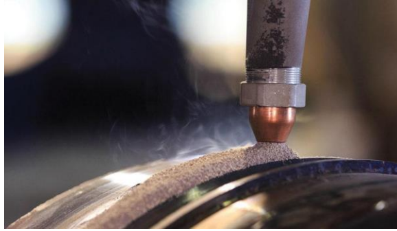
Εικόνα 3- 12. Μέθοδος συγκόλλησης SAW. Πηγή: Διδακτικές σημειώσεις καθηγήτριας Άννας Ζερβάκη, 'Συγκολλήσεις σε Αγωγούς (Εργοστασιακές/Εργοταξιακές)', Εργαστήριο Ναυπηγικής Τεχνολογίας, 2020
