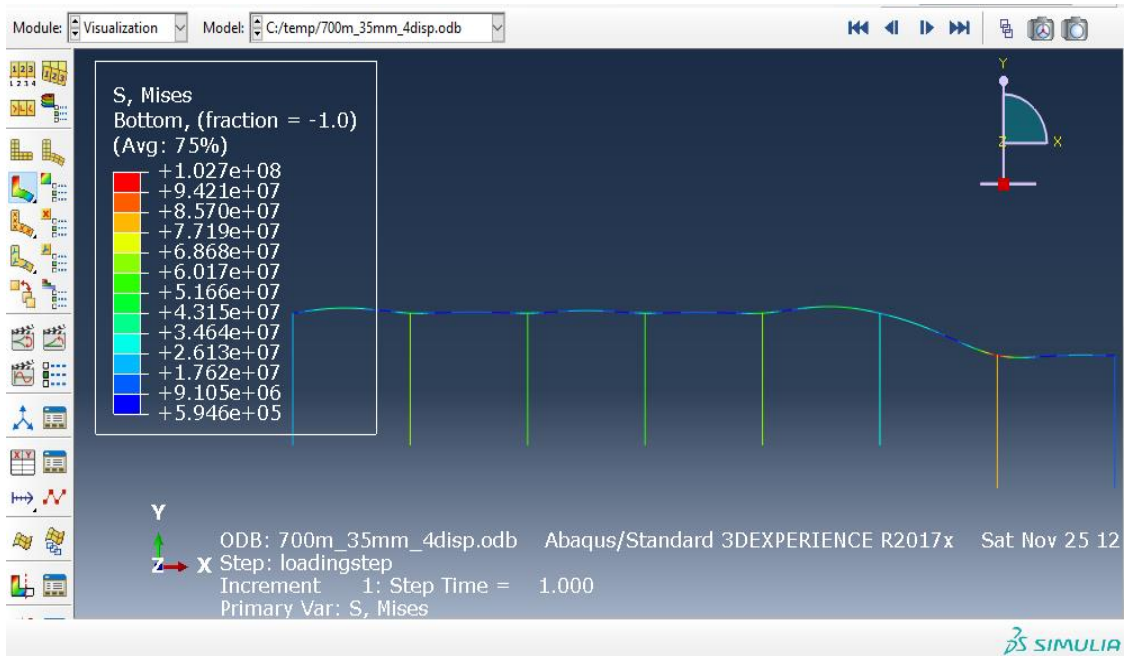
Εικόνα 5- 20. Καθίζηση εδάφους κατά 4 m σε 700 m μήκος αγωγού – Abaqus
