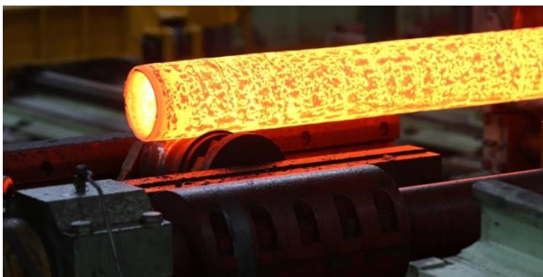
Εικόνα 3- 9. Κατασκευή τμημάτων αγωγού στο χαλυβουργείο. Πηγή: Eastern –Steels.com , Seamless Steel Pipe
