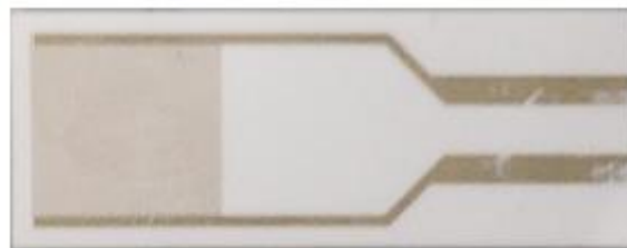
Εικόνα 2.3: Ο πυκνωτής ενδοδιαπλεκόμενων ηλεκτροδίων που χρησιμοποιήθηκε. 8
