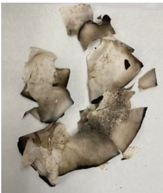
Σχήμα 6-17: Ξήρανση στους 50°C του στερεού μέρους της διήθησης του όξινου διαλύματος.
