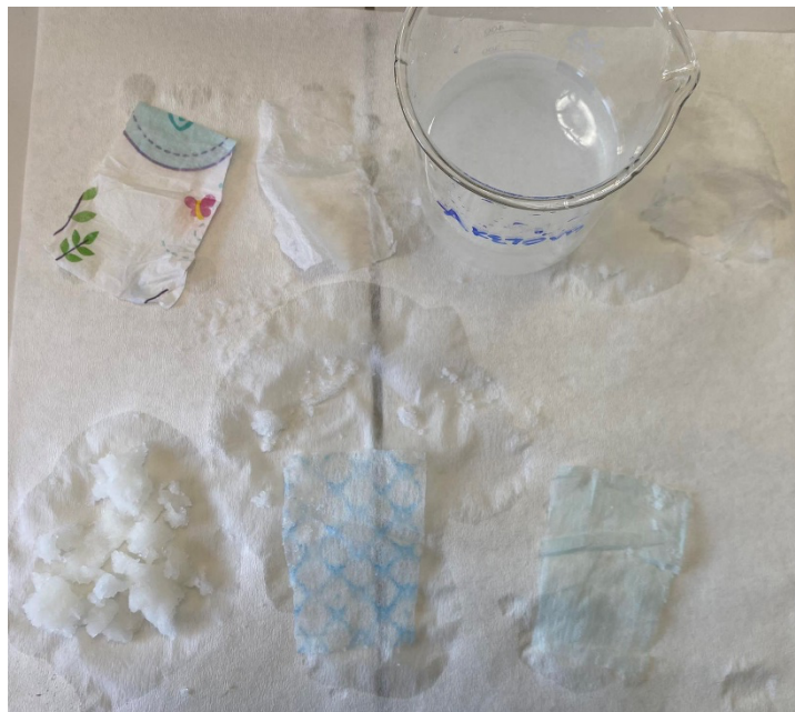
Σχήμα 6-8: Διαχωρισμένα στρώματα της ενυδατωμένης πάνας από την ακετόνη
