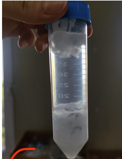
Σχήμα 5-4:Ενυδατωμένη πάνα μέσα σε διάλυμα αλατιού μετά από φυγοκέντρηση
