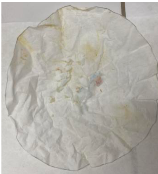
Σχήμα 6-23: Ξήρανση στους 50°C του στερεού μέρους της διήθησης του ενζυμικού διαλύματος.
