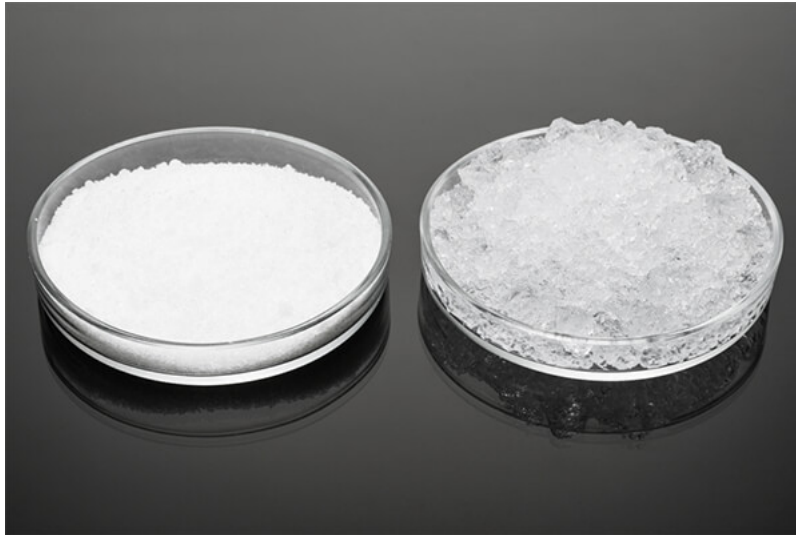
Σχήμα 3-1: Το SAP χωρίς την παρουσία νερού (αριστερά) και το SAP διογκωμένο (δεξιά)
