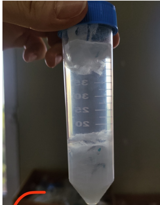
Σχήμα 6-12: Φυγοκέντρωση τεμαχισμένης πάνας με προσθήκη 20% w/v NaCl
