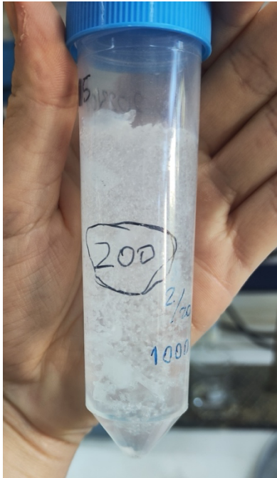
Σχήμα 6-13: Φυγοκέντρωση τεμαχισμένης πάνας χωρίς την προσθήκη NaCl
