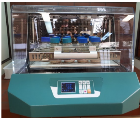
Σχήμα 4-1: Ανακινούμενο υδατόλουτρο IKA KS 30001 control.
