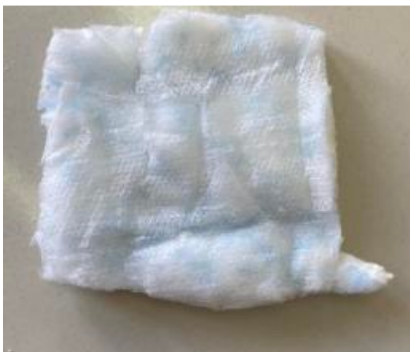
Σχήμα 5-2: Στεγνό κομμάτι πάνας που βυθίστηκε σε ακετόνη
