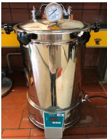
Σχήμα 4-4: Κλίβανος αποστείρωσης ISOLAB Laborgerate GmbH Autoclave
