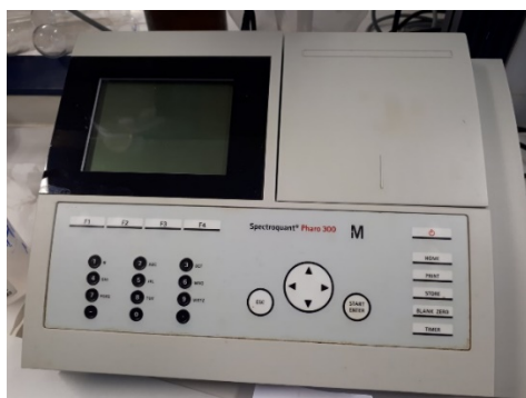
Σχήμα 4-3: Φωτόμετρο Spectroquant Pharo 300 Merck.
