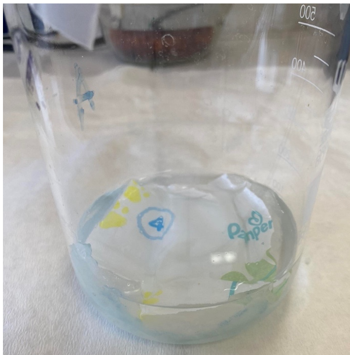
Σχήμα 6-4: Κομμάτι πάνας βυθισμένο σε αιθανόλη.
