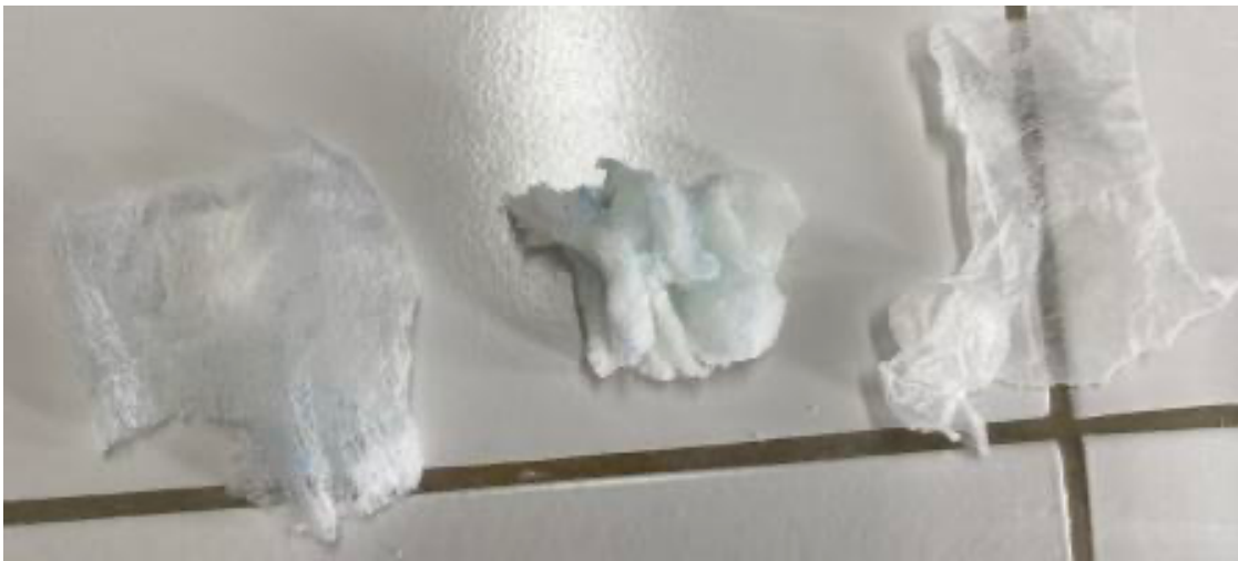
Σχήμα 6-3: Στρώμα της πάνας που εμπεριέχει τον πολτό βαμβακιού.
