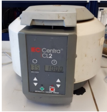
Σχήμα 4-2: Φυγόκεντρος IEC CENTRA CL2.
