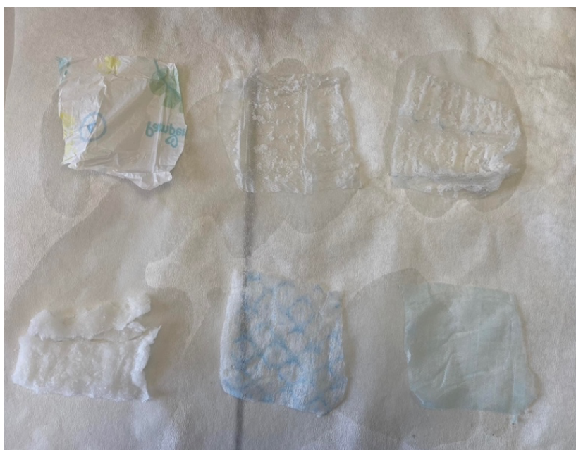
Σχήμα 6-5: Διαχωρισμένο κομμάτι πάνας μετά από την επίδραση της αιθανόλης.
