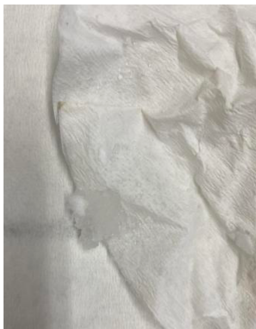
Σχήμα 6-26: Ξήρανση στους 50°C του στερεού μέρους της διήθησης του υδατικού διαλύματος.
