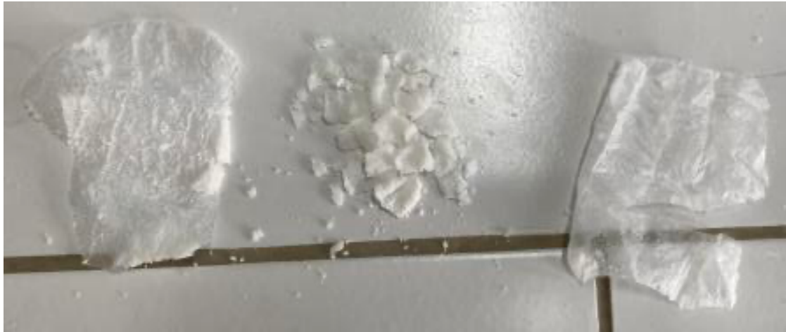
Σχήμα 6-2: Στρώμα της πάνας που εμπεριέχει το SAP.
