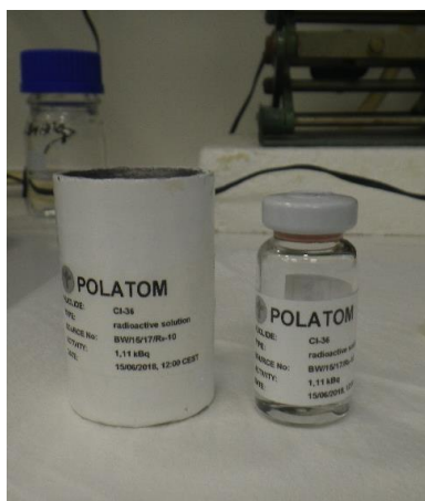
Εικ. 5.3 Δεξιά: Η αμπούλα με το πρότυπο διάλυμα Cl-36 (-β εκπομπός), Αριστερά: η μολύβδινη θωράκιση για τη μεταφορά του διαλύματος.
