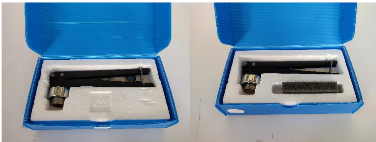
Εικ. 5.5 Συσκευές σφράγισης (αριστερά) και αποσφράγισης (δεξιά) φιαλιδίων όπως της Εικόνας 5.4
