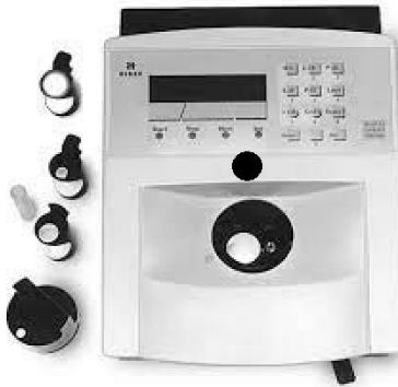
Εικ. 6.3 Θέση του φωτοπολλαπλασιαστή στο εσωτερικό του TRIATHLER (κάτω από τη βούλα, από το διαδίκτυο)
