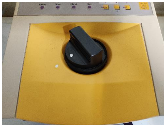
Εικ. 6.8 Φωτοστεγανό κάλυμμα του θαλάμου του TRIATHLER στην ανοικτή θέση
