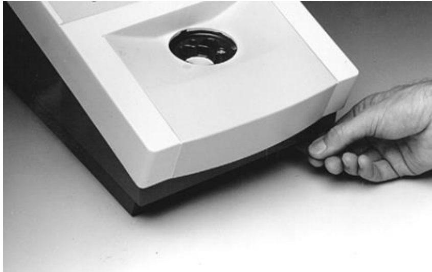
Εικ. 6.11 Χειρισμός μοχλού μετακίνησης ανιχνευτή NaI (από το διαδίκτυο)
