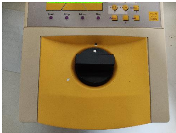
Εικ. 6.9 Φωτοστεγανό κάλυμμα του θαλάμου του TRIATHLER στην κλειστή θέση
