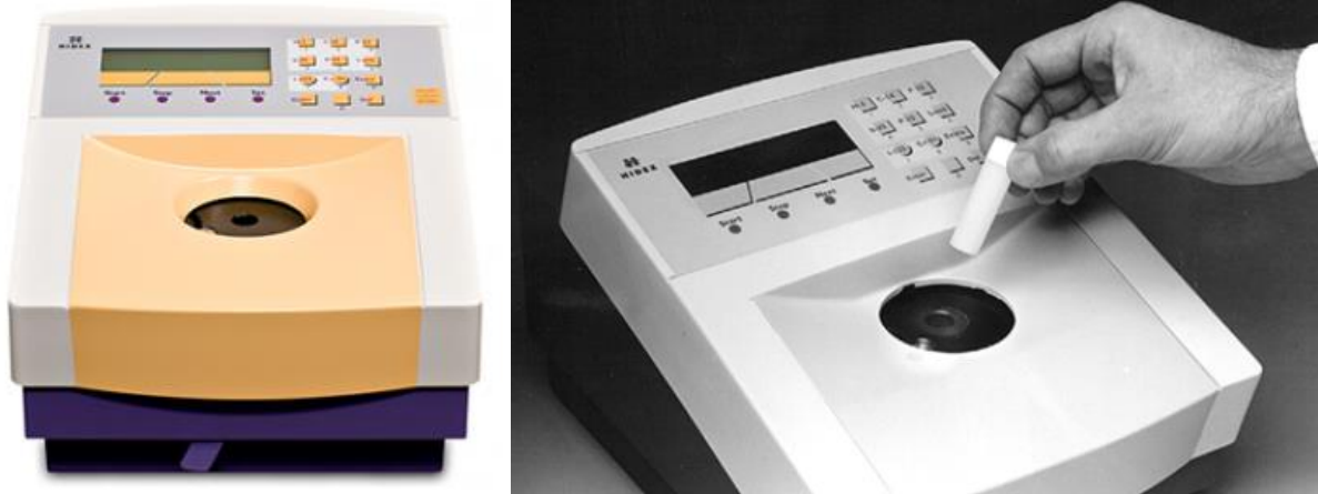
Εικ. 6.12 Άνοιγμα θαλάμου για μέτρηση με τον ανιχνευτή NaI (από το διαδίκτυο)
