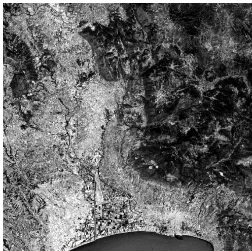
Σχήμα 34. Λόγος Red(B4)/Green(B3) φασματικών καναλιών πολυφασματικής απεικόνισης Sentinel-2A, με ημερομηνία λήψης 17/07/2023
