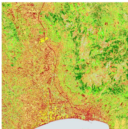
Σχήμα 38. Μη Επιβλεπόμενη Ταξινόμηση, Αλγόριθμος K-Means, με 23 τάξεις
