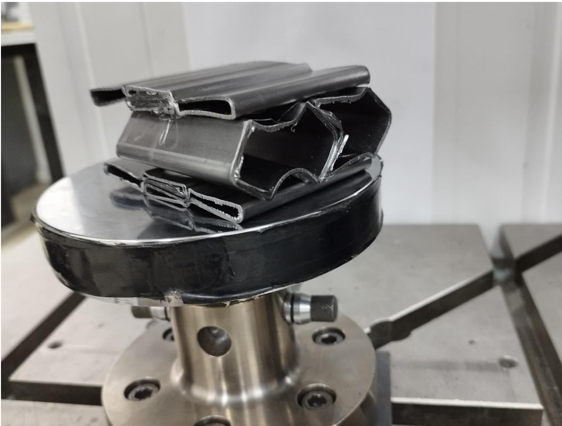
Εικόνα 5.2. Δοκίμιο R2_S μετά την κατάρρευση
