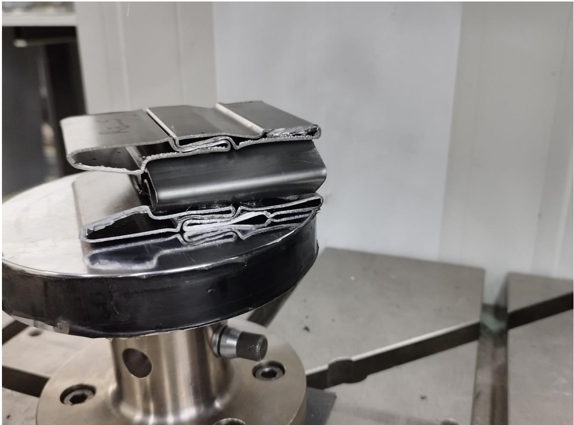
Εικόνα 5.3. Δοκίμιο R3_S μετά την κατάρρευση
