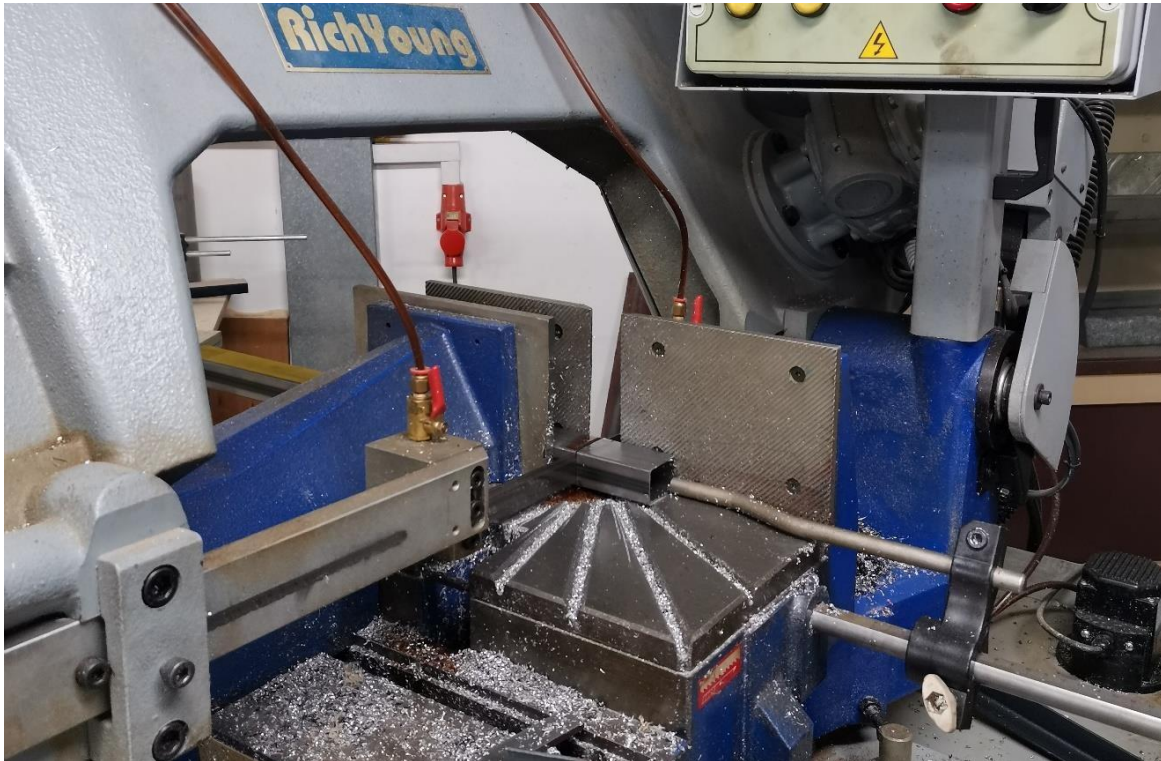
Εικόνα 4.1. Διαδικασία κοπής δοκίμιων με ηλεκτρικό πριόνι
