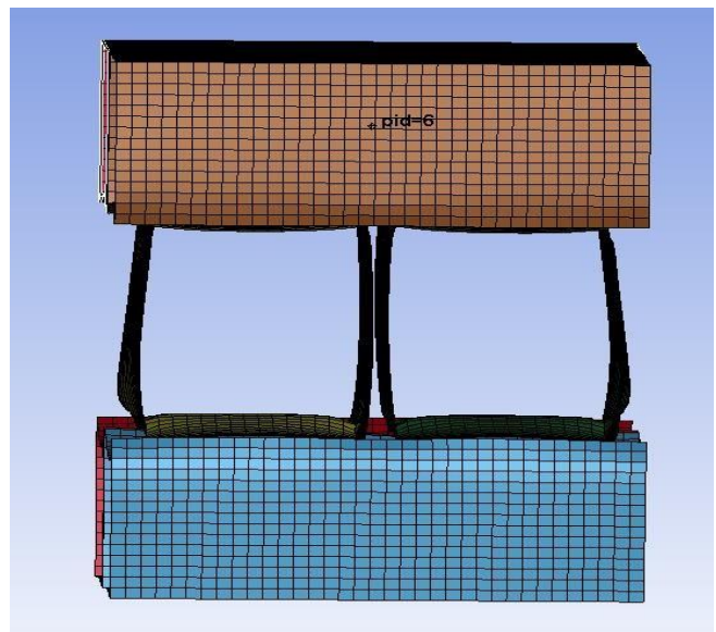
Εικόνα 6.26. Πρόσοψη και πλάγια όψη δοκιμίου R3_D στην αρχή της προσομοίωσης κρούσης
