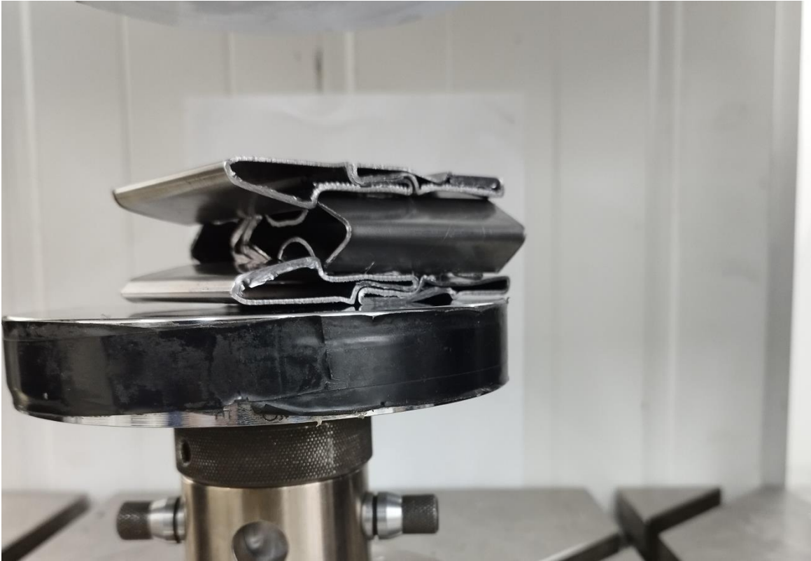
Εικόνα 5.4. Δοκίμιο R4_S μετά την κατάρρευση
