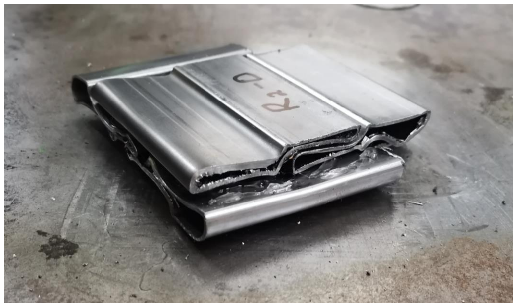
Εικόνα 5.2. Δοκίμιο R2_D, μετά την κρούση
