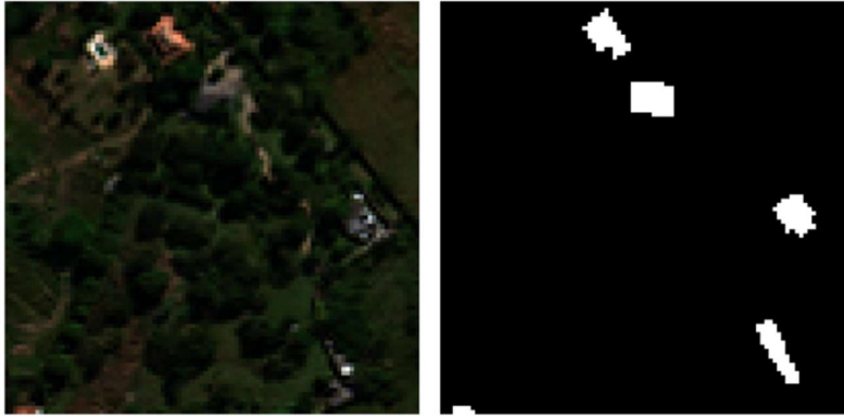
Εικόνα 20. Απεικόνιση των δεδομένων εισόδου 1ου σεναρίου. Αριστερά στήλη οι δορυφορικές εικόνες RGB (input RGB images). Δεξιά στήλη οι μάσκες των κτηρίων (ground truth labels).
