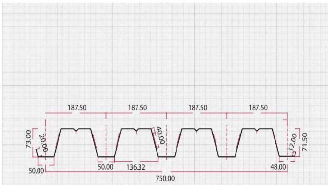
Σχήμα 3.18 Γεωμετρία χαλυβδόφυλλου.
