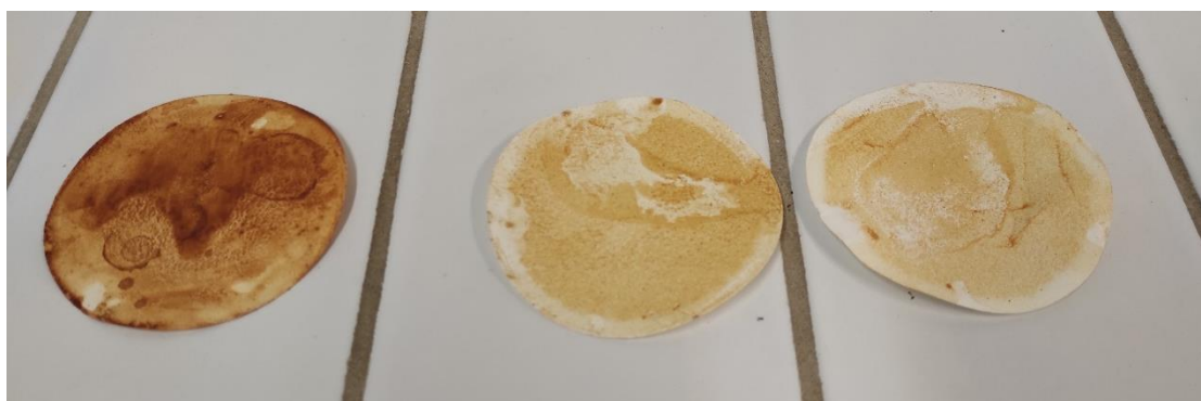
Σχήμα 5.23: Τα φίλτρα που προέκυψαν από την διήθηση του 'καθαρού' νερού του Σημείου -3, μετά τη διαδικασία ιζηματοποίησης
