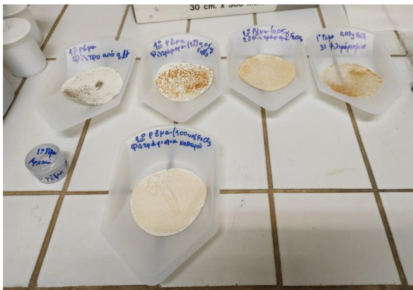
Σχήμα 5.14: Πρώτο αριστερά το αρχικό φιλτράρισμα (χωρίς \text{FeCl}_3 ) νερού. Δεξιά, τα τρία φίλτρα από το διάλυμα με 50 mg \text{FeCl}_3/\text{L} νερό. Κάτω, το φίλτρο από το διάλυμα με 100 mg \text{FeCl}_3/\text{L} δείγματος.
