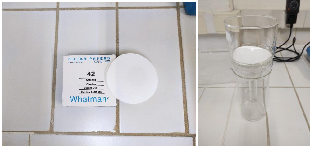
Σχήμα 5.9: Το φίλτρο χαρτιού που χρησιμοποιήθηκε στις δοκιμές, και η διάταξη στην οποία τοποθετείται
