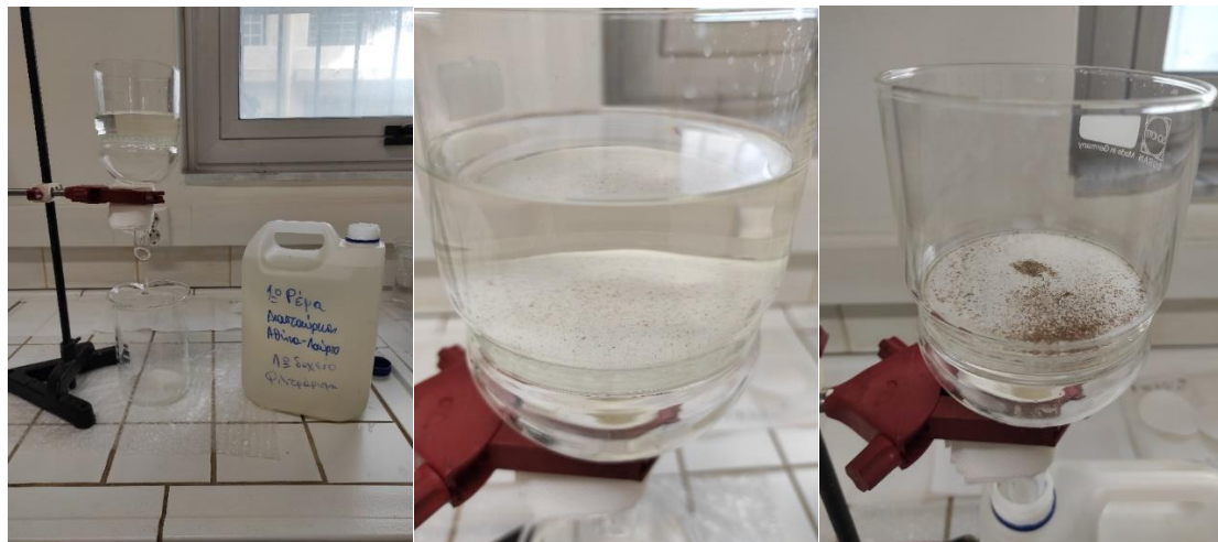
Σχήμα 5.10: Αρχικό φιλτράρισμα νερού από το 1ο σημείο (2 L), και το φίλτρο κατά την διάρκεια και στο τέλος της διαδικασίας
