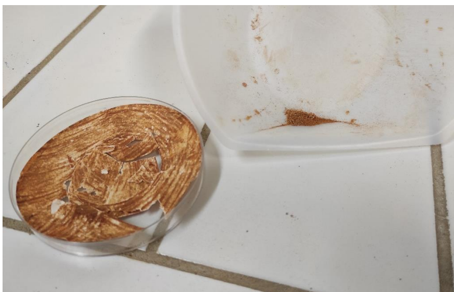
Σχήμα 5.31: Προσπάθεια μηχανικής απομάκρυνσης ιζήματος από το φίλτρο
