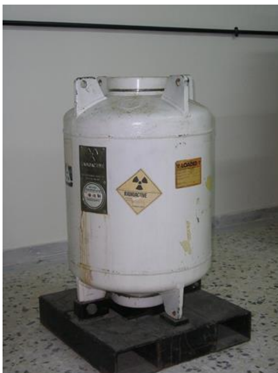
Σχήμα 4.10: Φωτογραφία της θωράκισης της πηγής Am-Be, 10Ci, του ΕΠΤ-ΕΜΠ για αποθήκευση ή μεταφορά [45].
