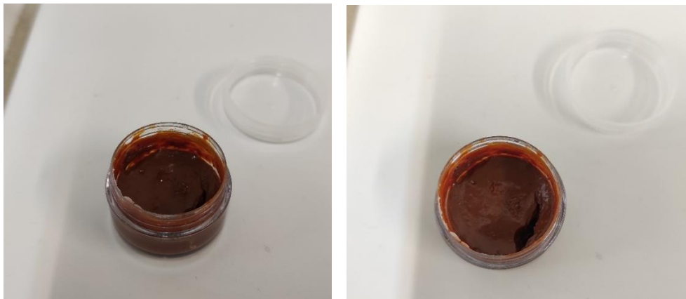
Σχήμα 5.26: Το ίζημα του πρώτου δοχείου των 4.3 L προς το τέλος της ξήρανσης
