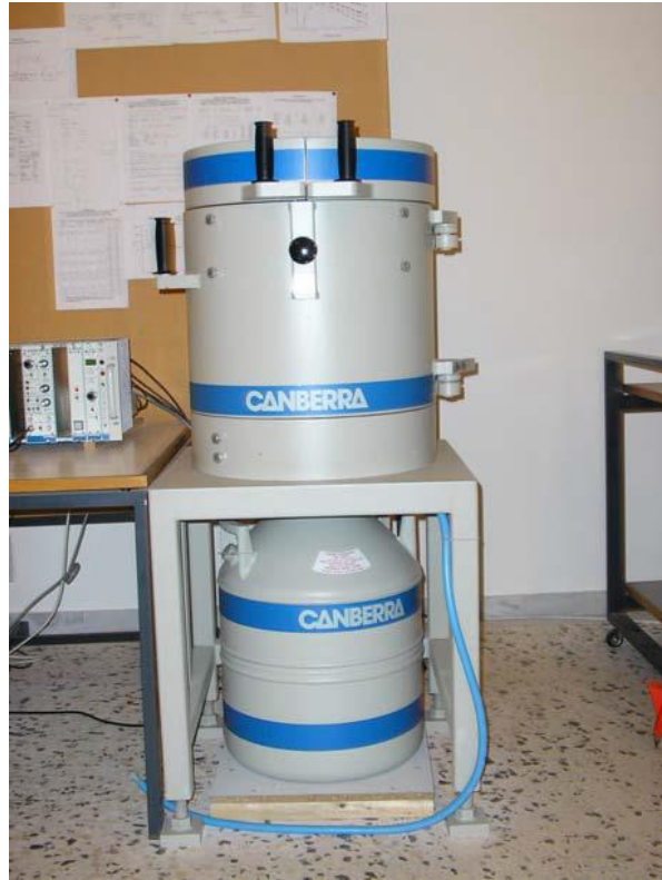
Σχήμα 4.12: Ο ανιχνευτής XtRa του ΕΠΤ-ΕΜΠ. Κάτω το δοχείο υγρού αζώτου [45].
