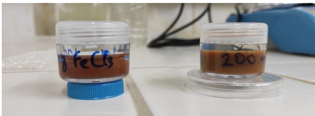
Σχήμα 5.19: Τα δύο αρχικά ιζήματα από τα δύο δείγματα με 100 mg FeCl 3 /L.
