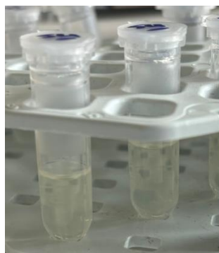
Εικόνα 12: Μεταβολή χρώματος εξαιτίας της αντίδρασης υδρόλυσης του παλμιτικού p-νιτροφαινολεστέρα σε δείγματα διαλυτοποιημένης ευτηκτογέλης.
