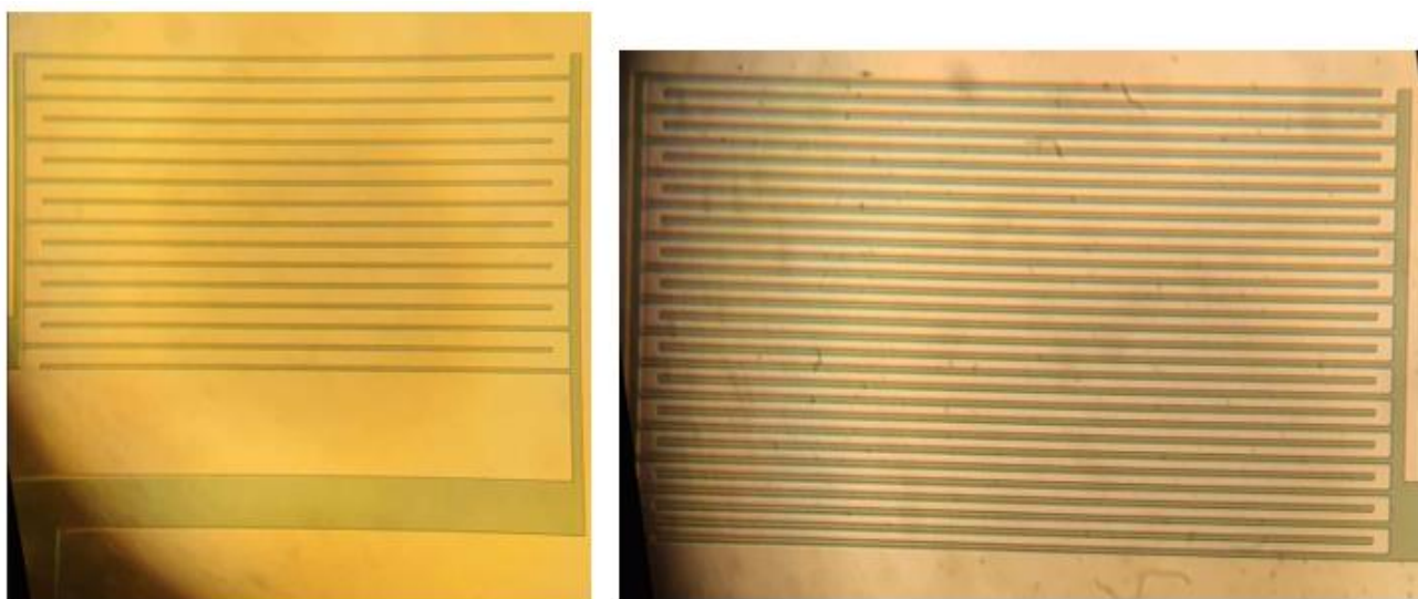
Σχήμα 33 : Αποτελέσματα θετικής λιθογραφίας για 30 και 10 \mu\text{m}
