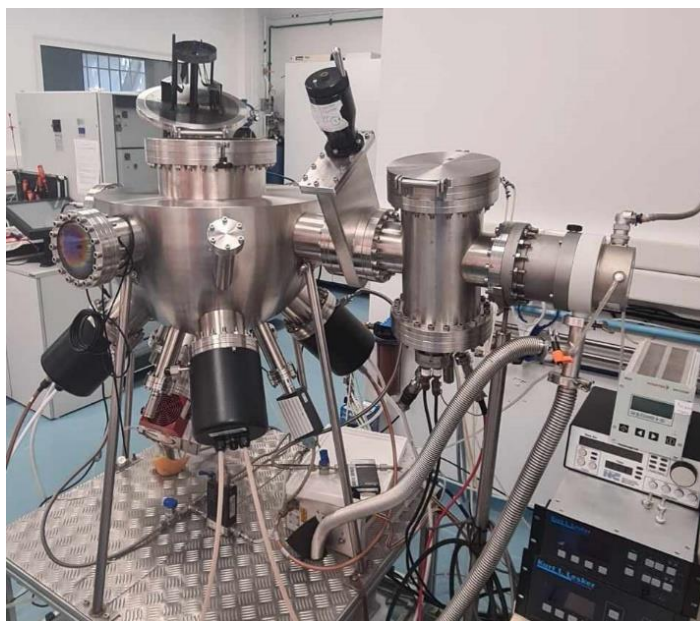
Σχήμα 45: RF magnetron sputtering, E-gun, thermal evaporator και Nanogen. Το e-gun χρησιμοποιήθηκε για την επιμετάλλωση με Ti, ενώ ο thermal evaporator για την επιπρόσθετη επιμετάλλωση με Au. Η Nanogen χρησιμοποιήθηκε για την εναπόθεση Pt NPs. Όλα τα συστήματα λειτουργούν υπό υψηλό κενό.
