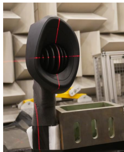
Σχήμα 11: Ευθυγράμμιση της πειραματικής γεωμετρίας και των μικροφώνων με χρήση laser.
