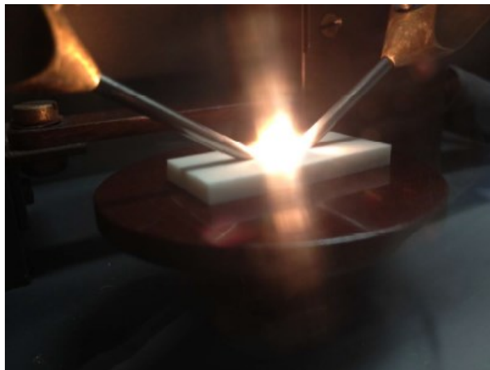
Σχήμα 2-28. Παράδειγμα εκτέλεσης της δοκιμής προσδιορισμού της αντίστασης σε εκκενώσεις υπό υψηλή τάση και χαμηλό ρεύμα, όπου φαίνεται το τόξο (ρεύμα) που δημιουργείται στην επιφάνεια του δοκιμίου[130].
