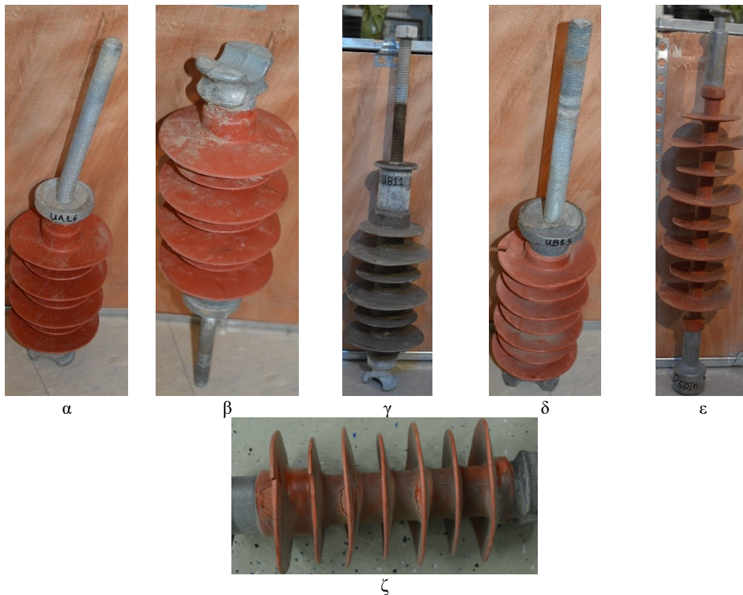
Σχήμα 3-5. Οπτική επιθεώρηση σε μεταχειρισμένους μονωτήρες: (α) UA16, (β) UA13, (γ) UB11, (δ) UB15, (ε) UB25, (ζ) UB15.
