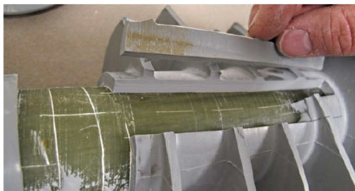
Σχήμα 2-40. Αναπαράσταση της αποκόλλησης του περιβλήματος από τη ράβδο (adhesive failure) και του σκίσιματος του μονωτικού περιβλήματος (cohesive failure) [175].
