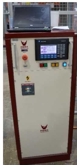
Σχήμα 3-95. α) Επίπεδες μεταλλικές πλάκες μεταξύ των οποίων εφαρμόζεται η απαιτούμενη AC τάση, και β) συσκευή που χρησιμοποιείται για τη δοκιμή και περιλαμβάνει μετασχηματιστή 100 kV.
