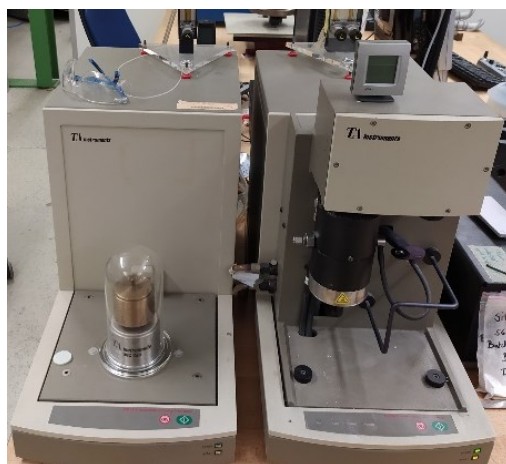
Σχήμα 3-80. Συσκευή εκτέλεσης της δοκιμής θερμοβαρουμετρικής ανάλυσης (TGA 2050 της TA Instruments).
