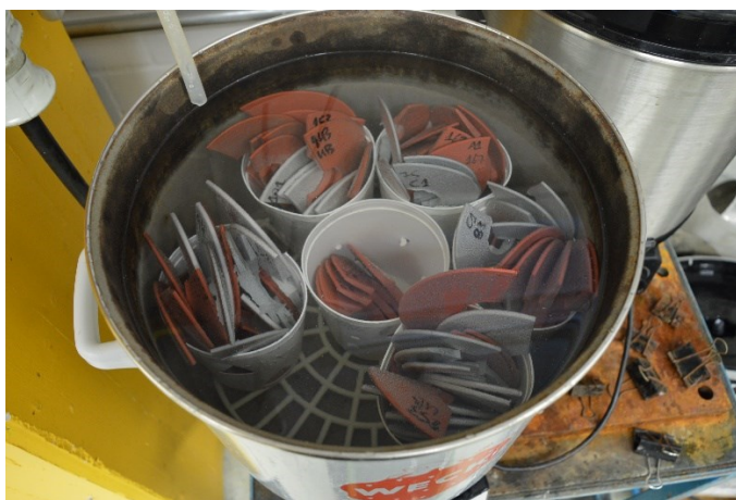
Σχήμα 3-118. Συσκευή βρασμού που χρησιμοποιήθηκε για την επιταχυνόμενη γήρανση των δοκιμίων και κυπελάκια με τα δοκίμια των μονωτήρων (1 ημέρας, 2 ημερών, 4 ημερών, 8 ημερών και 16 ημερών).
