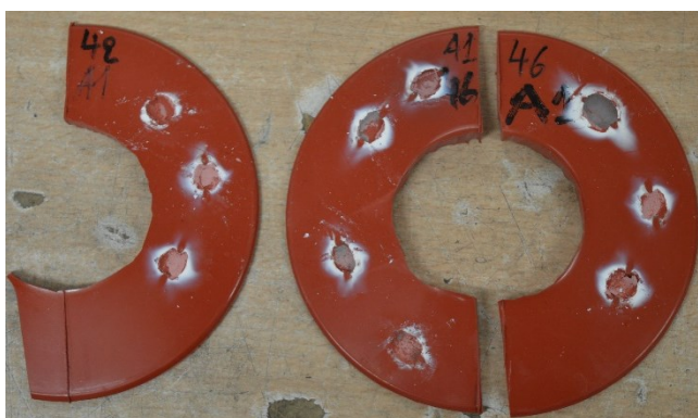
Σχήμα 3-89. Δοκίμια μετά τη δοκιμή αντίστασης σε εκκενώσεις υπό υψηλή τάση και χαμηλό ρεύμα.
