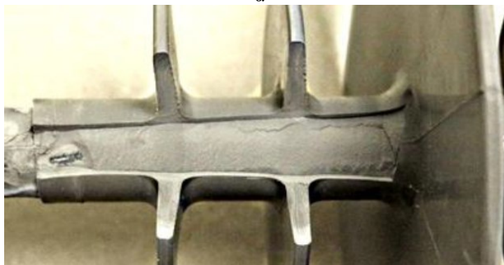
Σχήμα 2-41. α) Αποκόλληση του περιβλήματος από τη ράβδο (adhesive failure), β) σκίσιμο του μονωτικού περιβλήματος (cohesive failure) [173].
