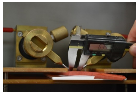
Σχήμα 3-87. α) Τοποθέτηση του δοκιμίου στη συσκευή και β) ρύθμιση της απόστασης των ηλεκτροδίων στα 6,35 mm.
