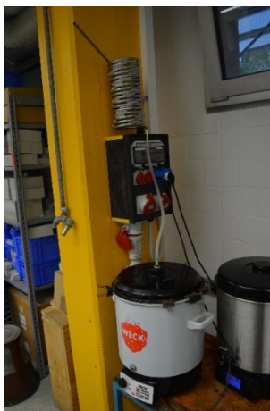
Σχήμα 3-20. Συσκευή (βραστήρας) που χρησιμοποιήθηκε για την καταπόνηση των κυαθίων των μονωτήρων σε βρασμό 42 ωρών.
