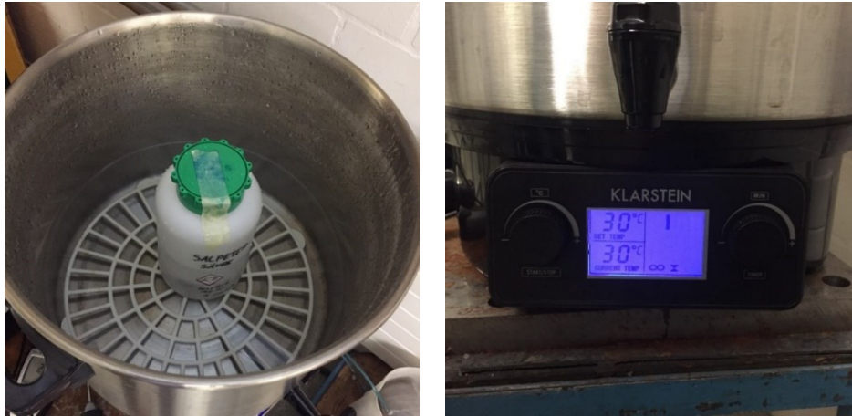
Σχήμα 3-92. Βύθιση του δοκιμίου στο διάλυμα νιτρικού οξέος, σε δοχείο από πολυαιθυλένιο και τοποθέτηση του, σε δεξαμενή γεμάτη με νερό, στους 30 °C για 100 ώρες.
