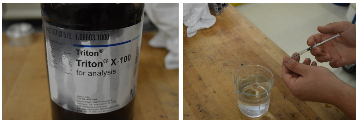
Σχήμα 3-38. Προσθήκη Triton – X 100 στο απιονισμένο νερό της μέτρησης ώστε να αποφευχθεί το φαινόμενο της δημιουργίας φυσαλίδων στο υπό μέτρηση δοκίμιο.
