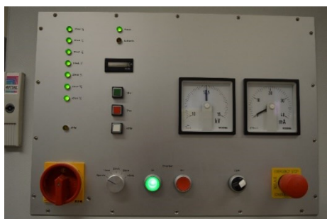
Σχήμα 3-88. α) Ρύθμιση της τάσης ανοιχτού κυκλώματος στα 12,5 kV, β) εκτέλεση της δοκιμής.
