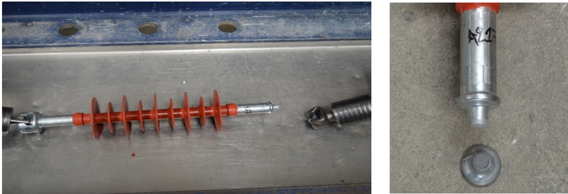
Σχήμα 3-102. α) Ο μονωτήρας A217 μετά την αστοχία του στη μηχανή εφελκυσμού και β) κοντινή όψη του σπασμένου κάτω μεταλλικού ακροδέκτη του μονωτήρα A217.
