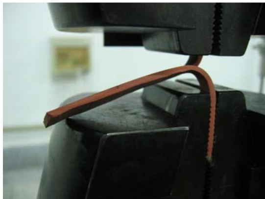
Σχήμα 2-13. Διεξαγωγή της δοκιμής προσδιορισμού της αντοχής σε σκίσιμο σε συνθετικό μονωτήρα με δοκίμιο τύπου «trouser» [105].
