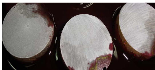
Σχήμα 2-37. α) Δοκίμια που περνάνε επιτυχώς τη δοκιμή διείσδυσης βαφής [164], β) δοκίμια που αποτυγχάνουν κατά τη δοκιμή αυτή μέσα στα 3 πρώτα λεπτά [157].
