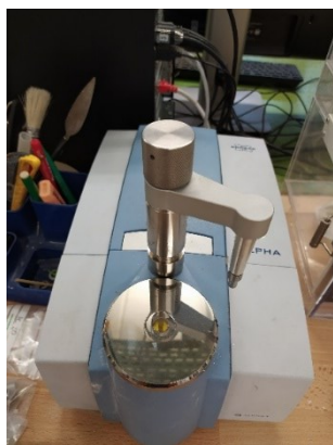
Σχήμα 3-77. Φασματόμετρο Alpha-E Bruker FTIR Spectrometer που χρησιμοποιήθηκε κατά τη δοκιμή α) μπροστινή όψη, β) πλάγια όψη.
