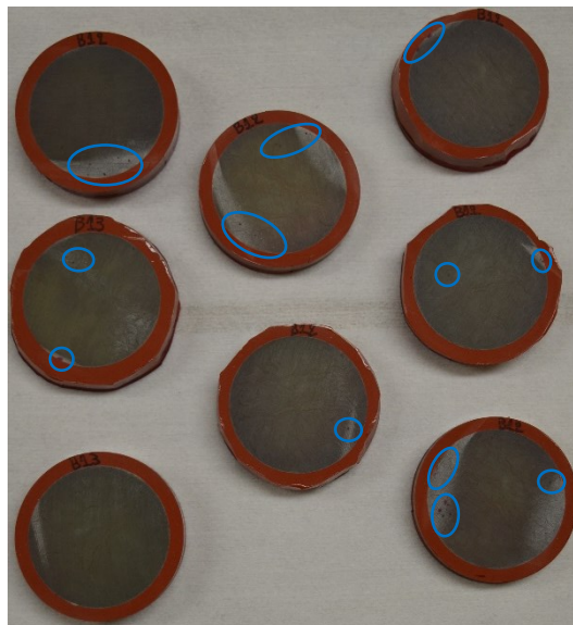
Σχήμα Γ - 5. Δοκίμια μονωτήρων B1 μετά τη δοκιμή διείσδυσης βαφής.
