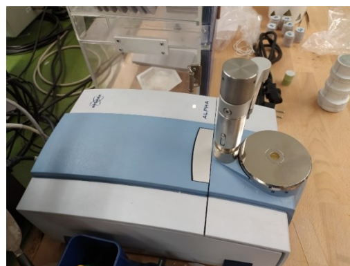
Σχήμα 3-77. Φασματόμετρο Alpha-E Bruker FTIR Spectrometer που χρησιμοποιήθηκε κατά τη δοκιμή α) μπροστινή όψη, β) πλάγια όψη.
