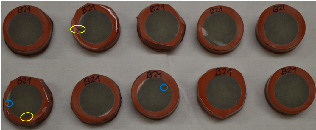
Σχήμα Γ - 9. Δοκίμια μονωτήρων B2 μετά τη δοκιμή διείσδυσης βαφής.
