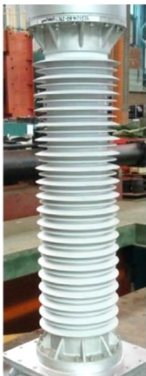
Σχήμα 1-11. α) Τυπικός συνθετικός μονωτήρας κοίλου πυρήνα [22], β) τομή του πυρήνα ενός συνθετικού μονωτήρα κοίλου πυρήνα[23].
