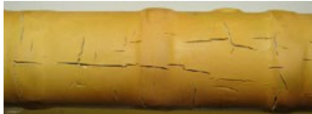
Σχήμα 2-31. Κομμάτι της ράβδου συνθετικού μονωτήρα καλυμμένο με μονωτικό περίβλημα από high temperature vulcanized (HTV) σιλικονούχο καουτσούκ (silicone rubber) μετά από έκθεση του σε διάλυμα νιτρικού οξέος για 5 μήνες [4].
