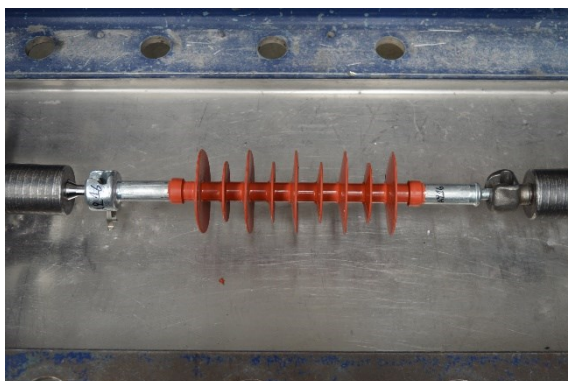
Σχήμα 3-101. Ο μονωτήρας A216 τοποθετημένος στη μηχανή εφελκυσμού για τη διεξαγωγή της δοκιμής εφελκυσμού (Έκδοση Α).
