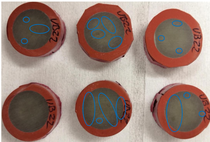
Σχήμα Γ - 10. Δοκίμια μονωτήρων UB2 (1 η ομάδα με 10 χρόνια στο δίκτυο) μετά τη δοκιμή διείσδυσης βαφής.
