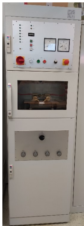
Σχήμα 3-86. Συσκευή Arc Resistance Tester – AENEA για εκτέλεση της δοκιμής αντίστασης σε εκκενώσεις υπό υψηλή τάση και χαμηλό ρεύμα.
