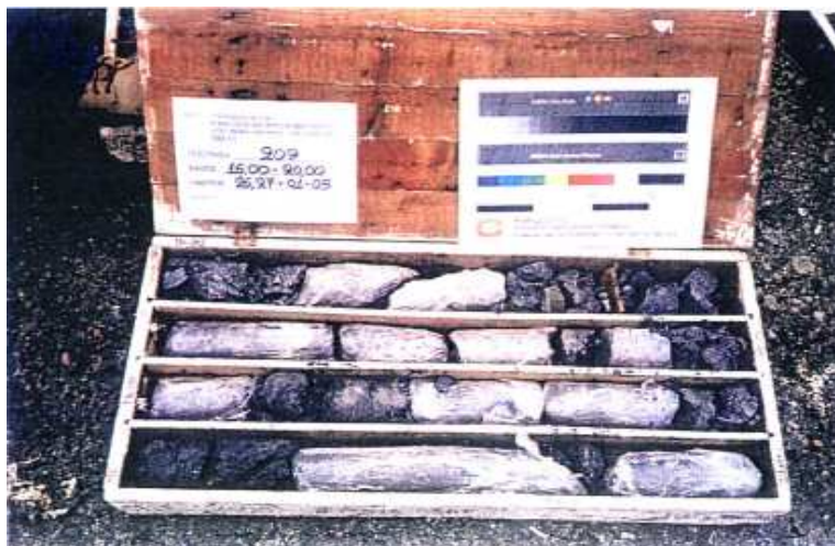
Εικόνα 8 : Πυρήνας γεώτρησης 209 (ISTRIA IR.D.T.612.B 2009)
