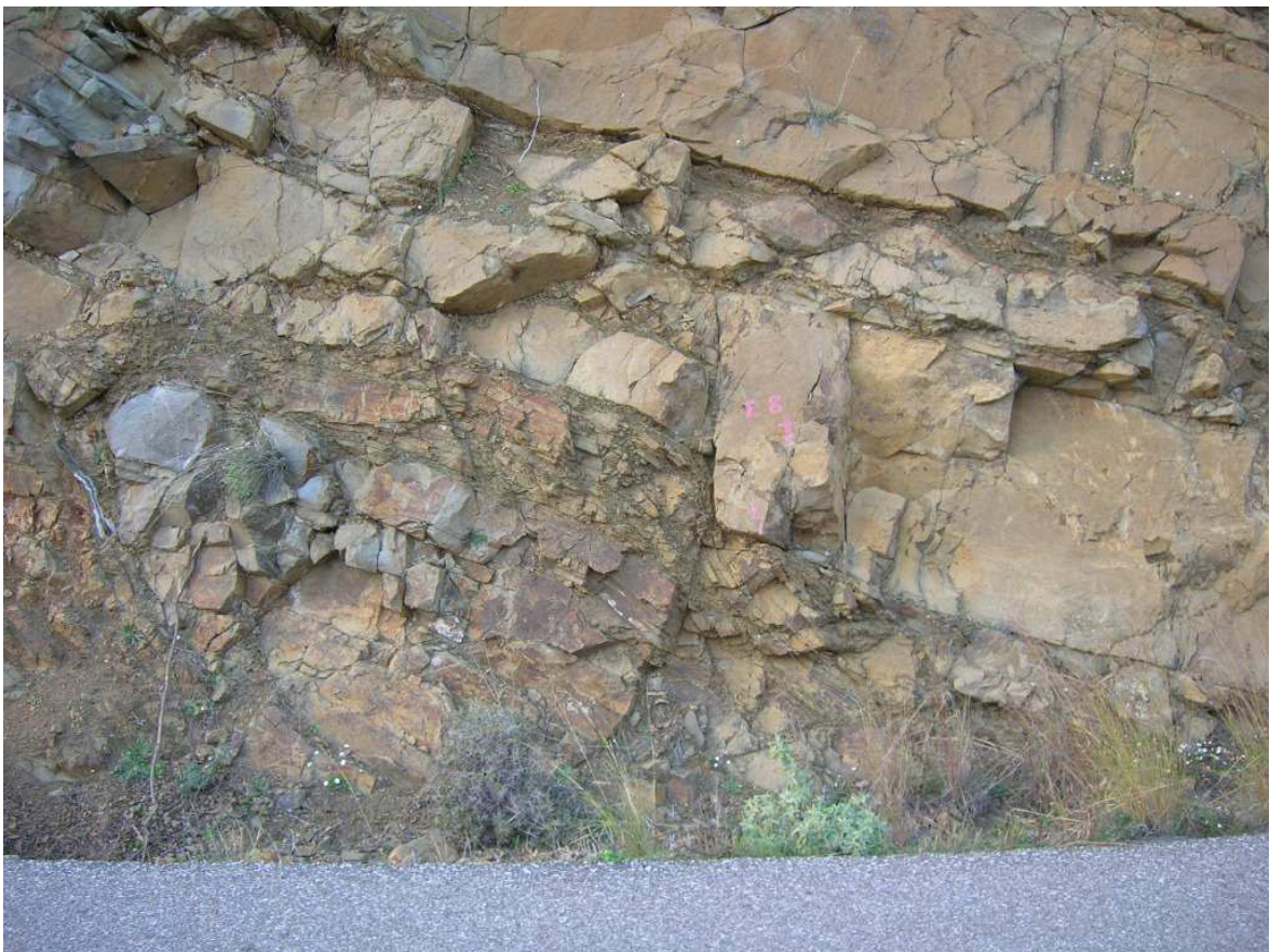
Εικόνα 3 : Ενδείξεις εσωτερικού ερπυσμού σε λεπτότερα στρώματα ψαμμίτη (ISTRIA IR.D.T.069.A)
