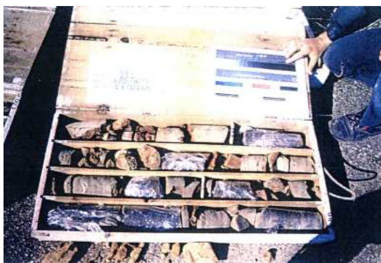
Εικόνα 10 : Πυρήνας γεώτρησης 211 (ISTRIA IR.D.T.612.B 2009)
