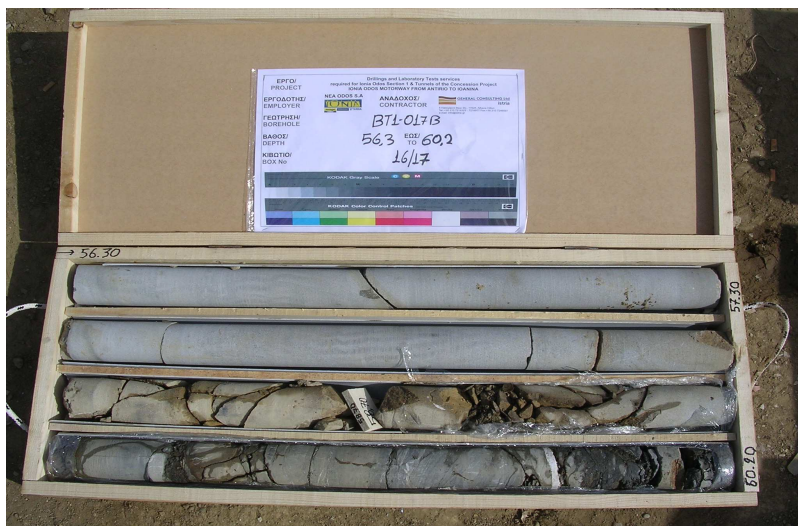
Εικόνα 6 : Πυρήνας γεώτρησης BT1 – 017B βάθους 56.30 – 60.20m (ISTRIA IR.D.T.612.B 2009)
