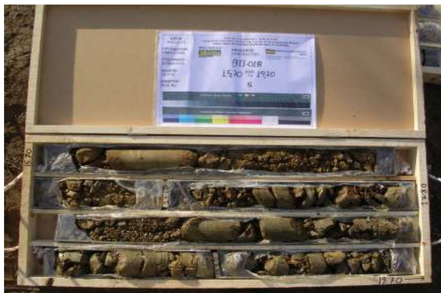
Εικόνα 7 : Πυρήνας γεώτρησης BT1 – 018 βάθους 15.70 – 19.70m (ISTRIA IR.D.T.612.B 2009)
